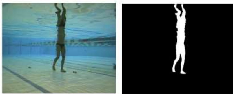
Figura 2.10: Esempio di frame originale dell'acquisizione ed estrazione della silhouette tramite segmentazione [14]
