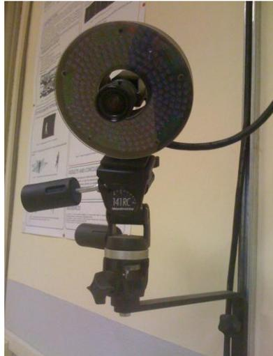
**Figura 3.0** Una delle 6 telecamere predisposte nel laboratorio di analisi del movimento dell'Università di Padova.
