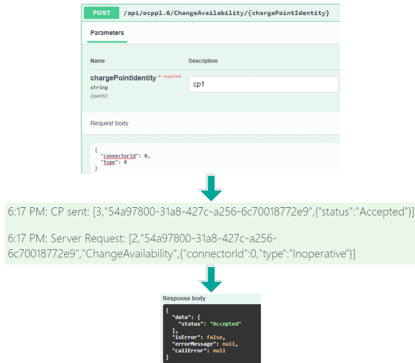
Figura 3.17: Flusso API sistema centrale → colonnina
