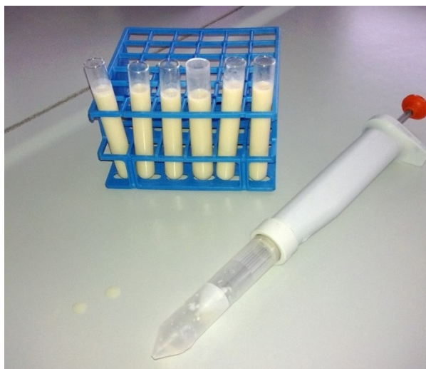
Figura 22 – provette contenenti campioni di bevanda a base di soia per la prova di stabilità termica
