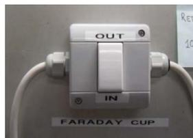
Figura 5.37: interruttore per inserimento \ disinserimento di Faraday Cup
