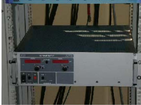
Figura 2.26: Alimentatore impiegato per fornire tensione alla piattaforma di alto voltaggio.
