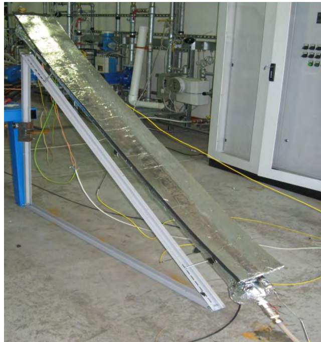
Figura 9.17 Modulo del collettore durante la prova con piastra isolata superiormente
