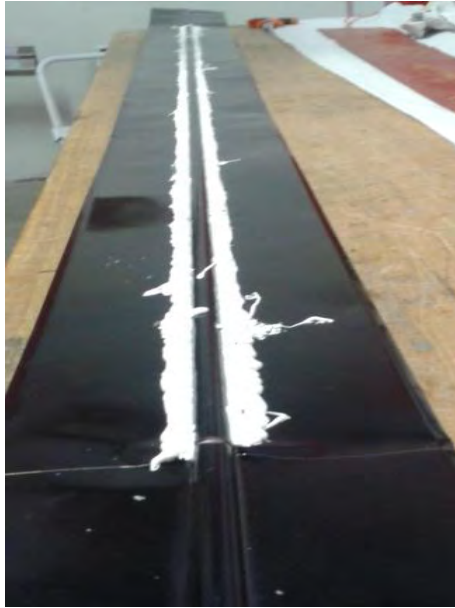
Figura 9.13 – Applicazione della pasta conduttiva sulla piastra
