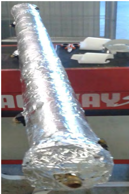
Figura 9.16 Isolamento del serbatoio
