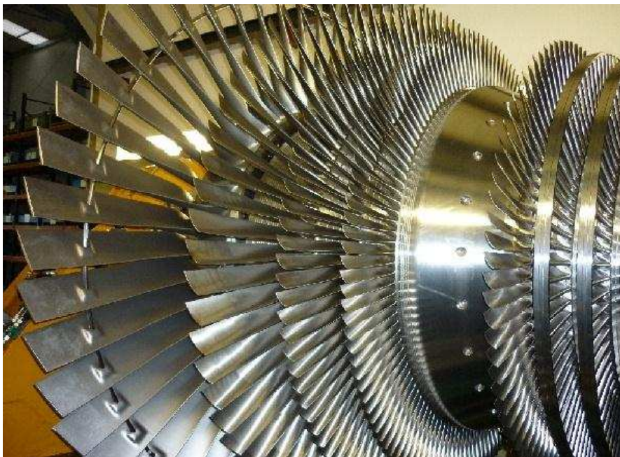
Figura 10 Turbina a gas per ciclo termico del termovalorizzatore
