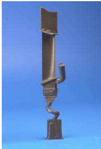
Figura 14 Paletta con solidificazione a monocristallo
