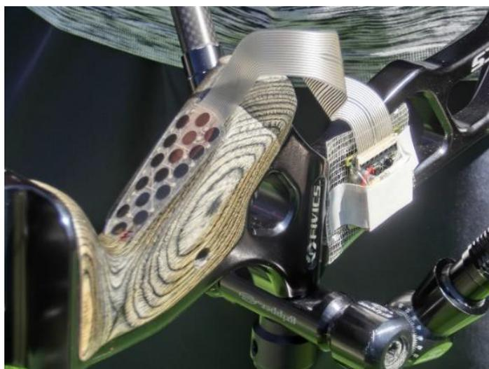
*Figura 2.2: Sensore IMU posizionato sull'arco.*
