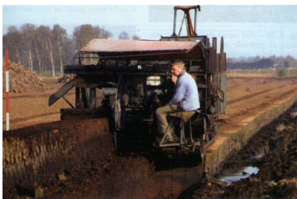
Fig. 4. Macchina zollatrice durante la raccolta della torba (Cattivello, 2009)
