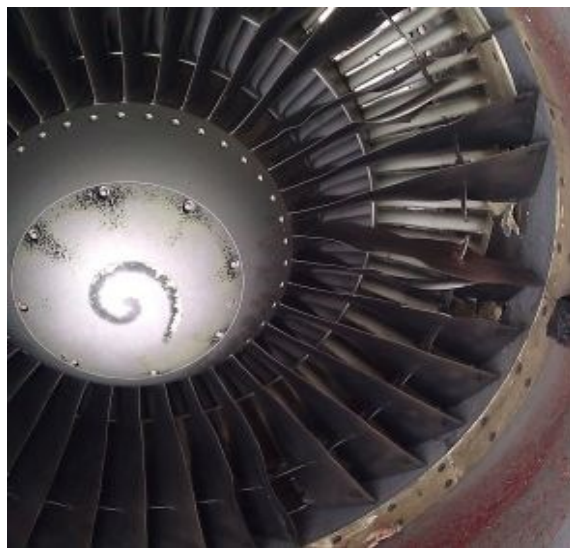
Figura 1.2: failure di alcune pale di un turbofan dopo un impatto. [www.faa.gov]
