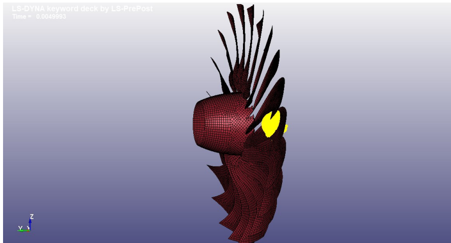
Figura 4.70: rappresentazione urto volatile-ventola, v=60 m/s, dopo 5 ms.
