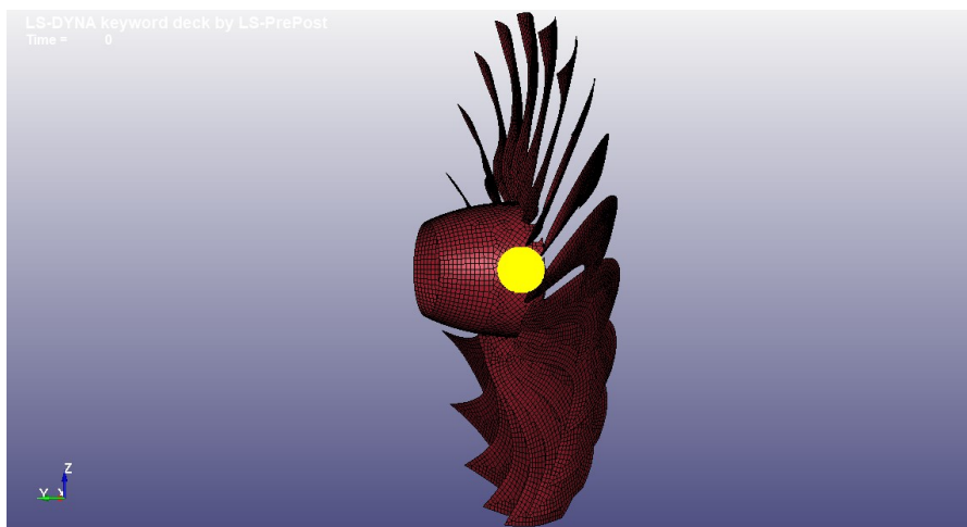
Figura 4.65: rappresentazione urto volatile-ventola, v=60 m/s, t=0 ms.
