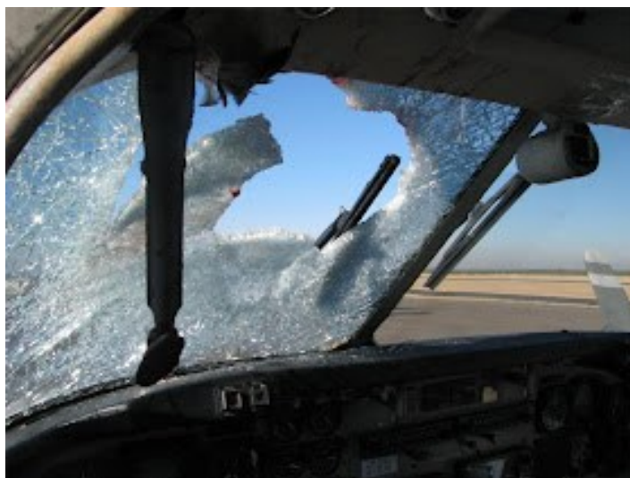
Figura 1.3: effetto dell'impatto tra un volatile e il parabrezza di un aereo. [“Bird strikes on planes lead to call for wildlife cull” (2021). www.thestar.com ]
