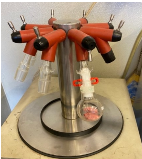
Figura 2.7: la liofilizzazione del campione "bianco"
