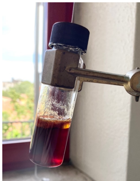
Figura 2.16: il campione di carne e PA12 dopo la sonicazione
