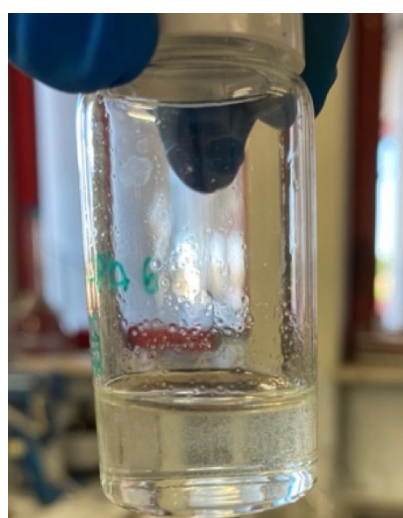
Figura 2.12: il campione 6, PA6, dopo la sonicazione
