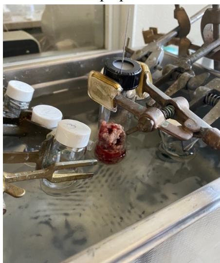
Figura 2.8: impostazione del sonicatore
