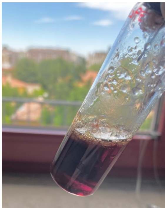
Figura 2.15: il campione di carne e LDPE dopo la sonicazione
