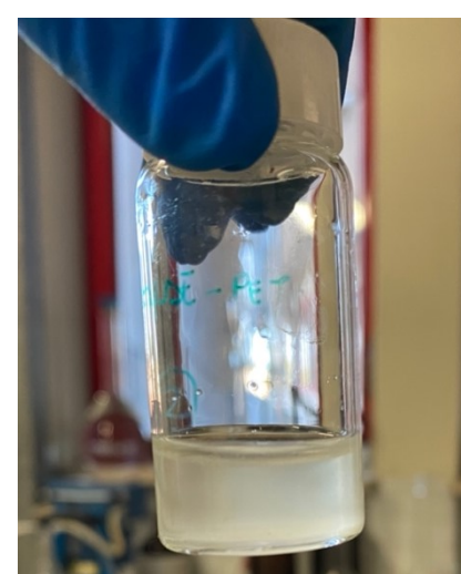
Figura 2.11: il campione 2, PET, dopo la sonicazione
