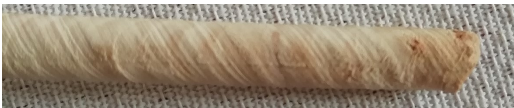
Figura 11.1.4: particolare della carota di abete bianco per la determinazione dell'età (area 12, particella 15): centrato il midollo.
