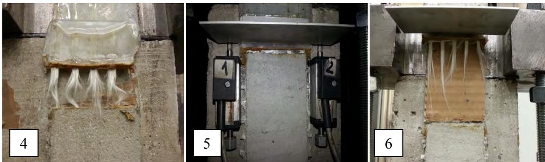
Figure 2-41 Particolari delle rotture nei provini testati. 1) rottura vicino alle piastrine in alluminio (DS\_GNET221B\_S\_330\_60\_1 rete non trattata); 2)-3) rottura del DS\_GNET221B\_S\_450\_60\_2 in sempre in corrispondenza alla ganascia superiore; 4) cedimento delle fibre al secondo tentativo di tiro del provino DS\_GNET221B\_S\_450\_60\_2; 5) rottura dei fasci all'inizio della zona incollata (DS\_GNET221B\_S\_330\_60\_3).
