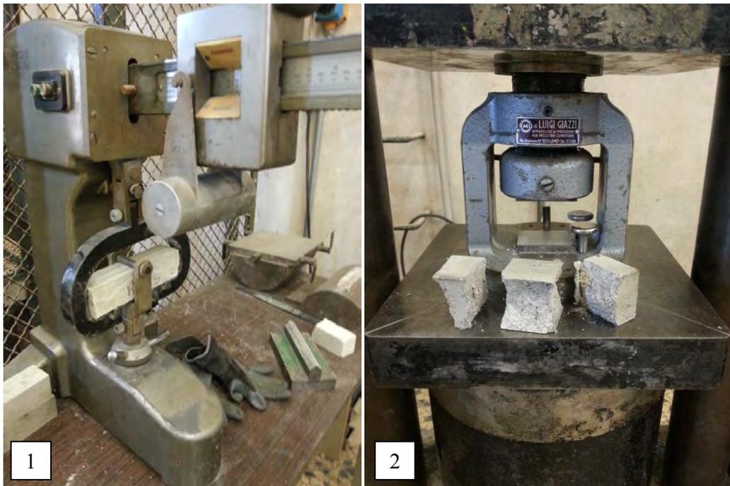
Figura 2-12 Particolare delle prove effettuate sui campioni di malta. 1) Prova a flessione; 2) test a compressione.
