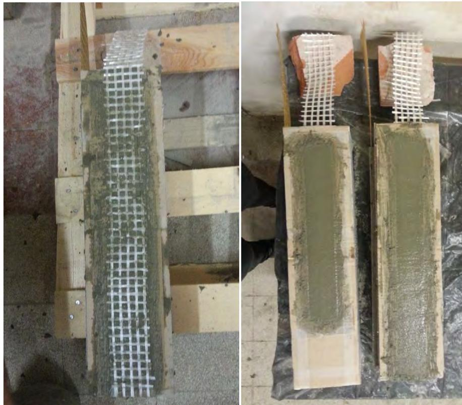
*Figura 2-8 A destra: applicazione della rete di rinforzo sopra allo strato di matrice. A sinistra: secondo layer di malta cementizia.*
