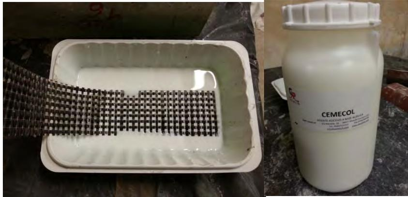
Figura 2-9 Impregnazione delle fibre di carbonio mediante colla a base acrilica.
