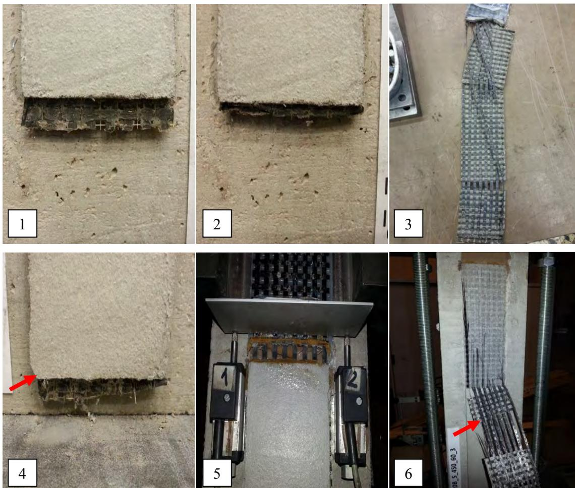
*Figura 2-51 1-2) Salita omogenea di tutte i fasci durante il test DS\_CNET220B\_S\_330\_60\_1 .3) Rottura del pacchetto che non ha evidenziato cedimenti dei fasci. 4-5) Salta disomogenea della rete durante la prova DS\_CNET220B\_S\_450\_60\_3 . 6) Rottura del pacchetto che ha evidenziato una lacerazione subita dai fasci che non avevano presentato scorrimento in fig.4 (freccia rossa).*
