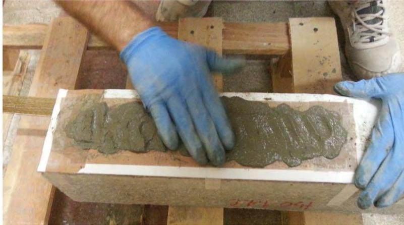
*Figura 2-7 Applicazione dello strato inferiore di matrice tramite l'ausilio della sagoma in cartone.*
