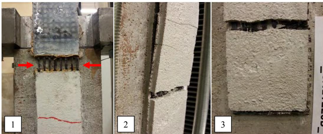
Figura 2-49 1) particolare della rottura del test DS\_CNET220B\_W\_330\_60\_1T. 2-3) rottura per distacco dello strato esterno di matrice durante la prova DS\_CNET220B\_W\_330\_60\_2.
