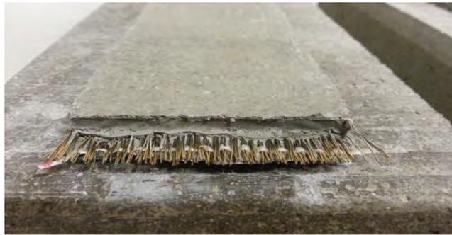
Figura 2-10 Particolare del provino.
