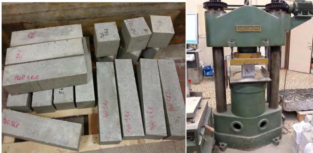
Figura 2-11 A sinistra: parallelepipedi e provini in calcestruzzo. A destra: esecuzione di una prova a compressione.
