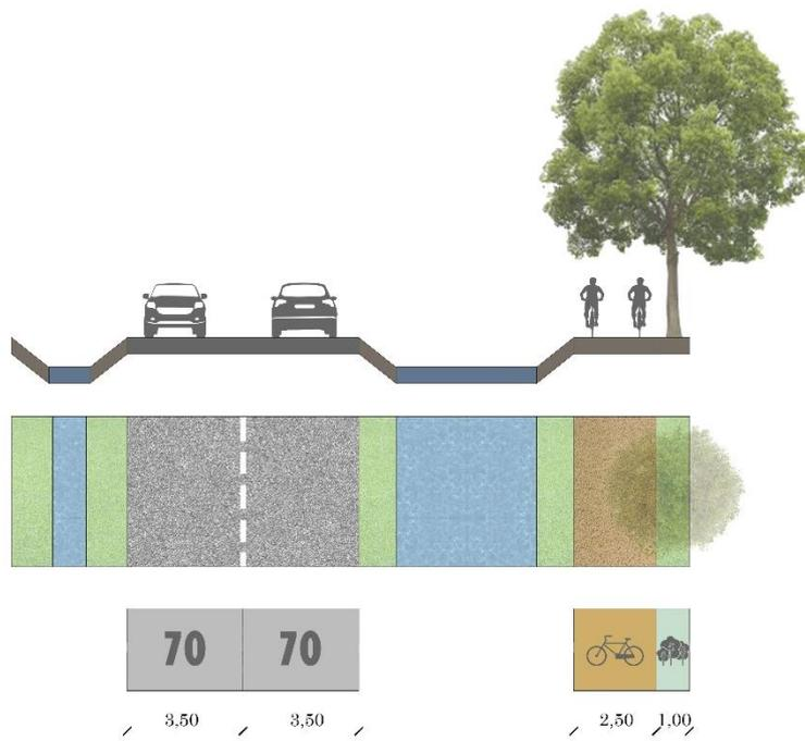
Fig. 53 Sezione stradale via Caltana con l'inserimento del nuovo tratto ciclabile in scala 1:250
