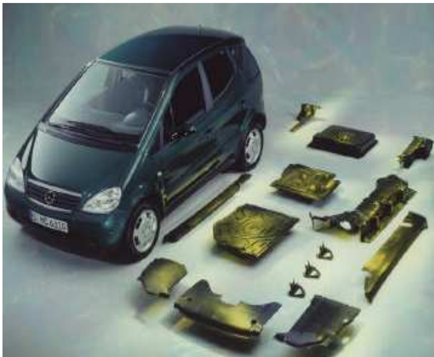
Fig. 3.13: Pannelli interni della Mercedes Classe-A realizzati in polipropilene rinforzato da fibre di lino
