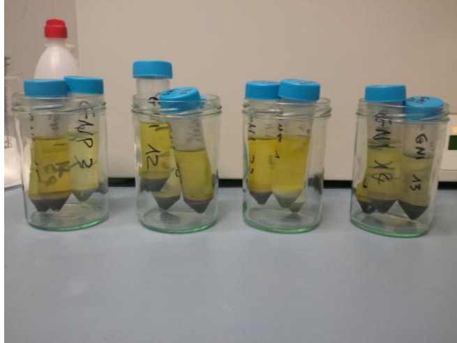
Figura 6 - Attacco con acido cloridrico diluito al 10%.
