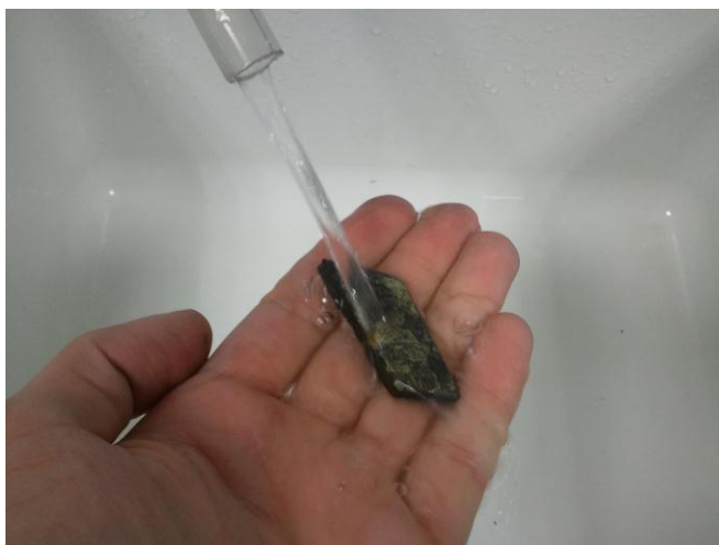
Figura 3 - Lavaggio e risciacquo con acqua deionizzata.
