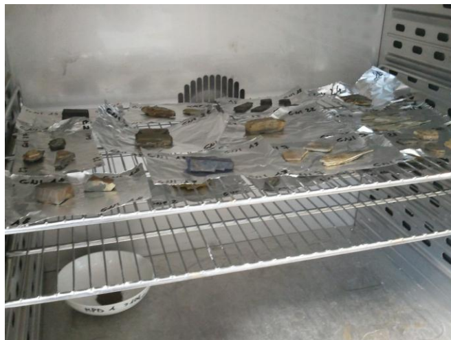
Figura 4 - Asciugatura dei campioni lavati.
