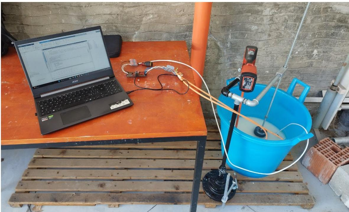
Figura 21: Set up con miscelatore per taratura
