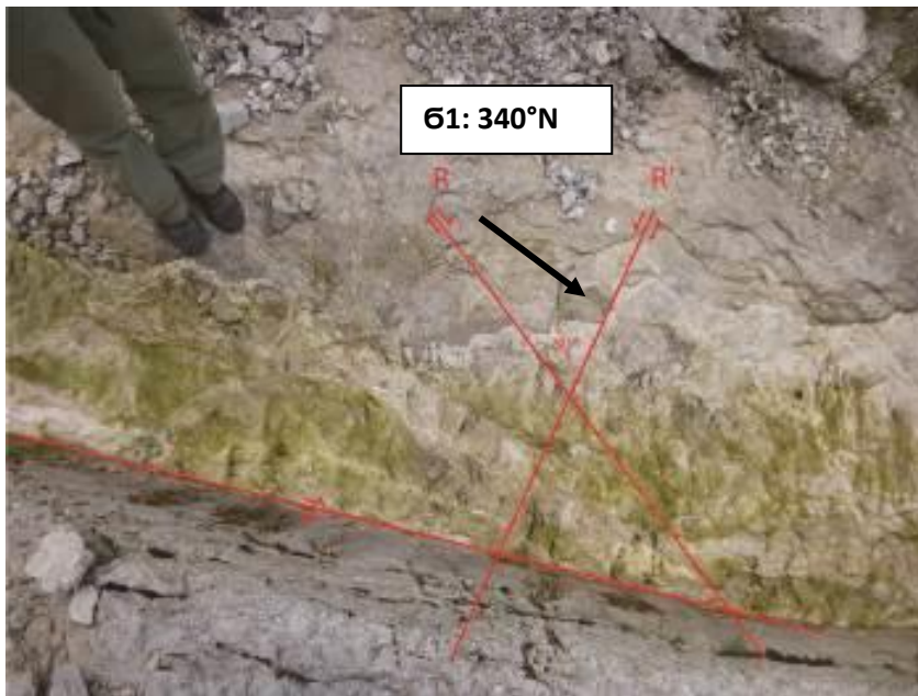
Figura 10 : Orientamento dello sforzo orizzontale massimo ( \sigma_1 ) da analisi di terreno e microstrutturali.
