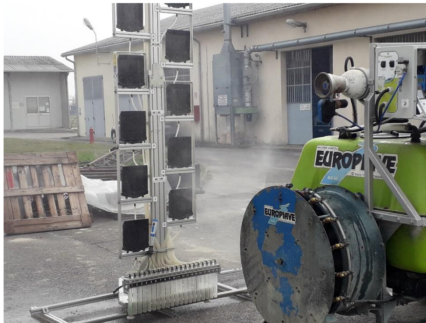
Figura 5.6. Banco di prova con irroratrice in funzione per misurazione ORP simulando situazione sulla vegetazione in campo
