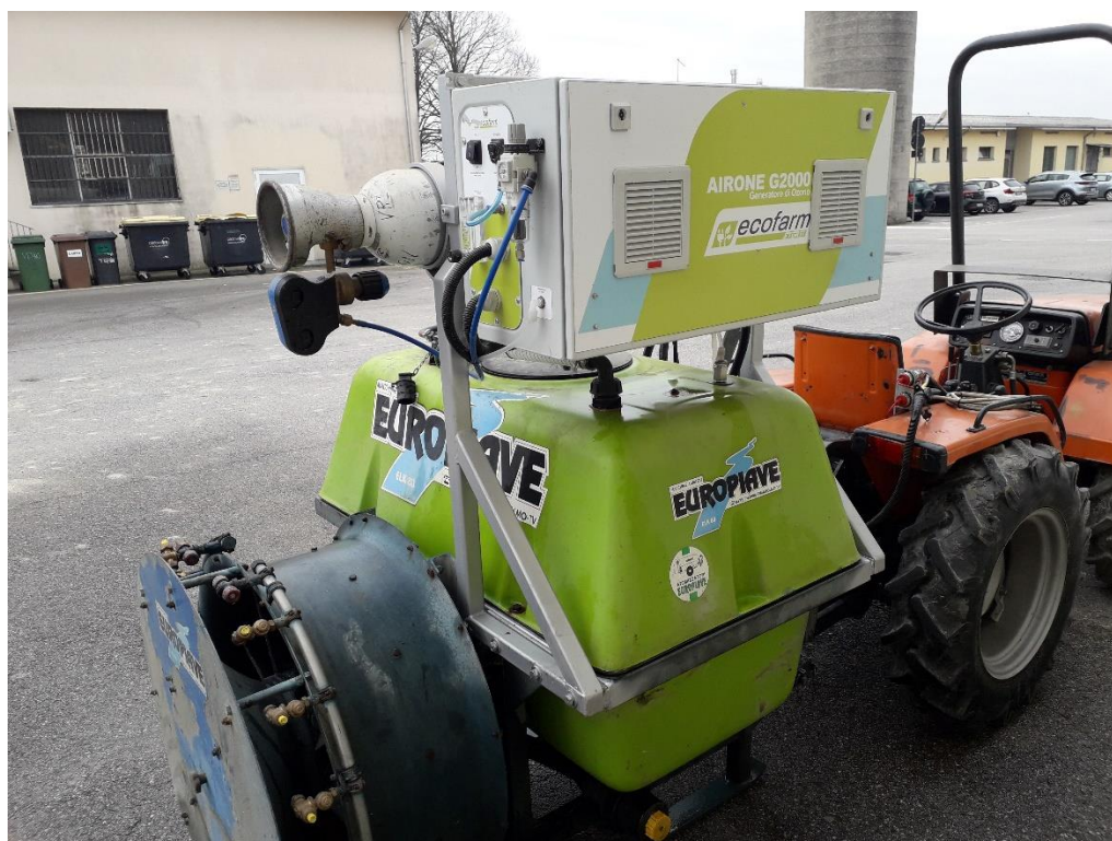
Figura 5.1. Generatore di ozono Airone G2000 - Ecofarm Storti montato su irroratrice portata ELK 88 Euro-piave (Cimadolmo -TV, Italia)
