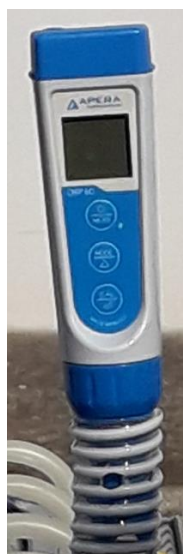
Figura 5.3. Tester ORP60 di Apera Instruments (Wuppertal, Germania)
