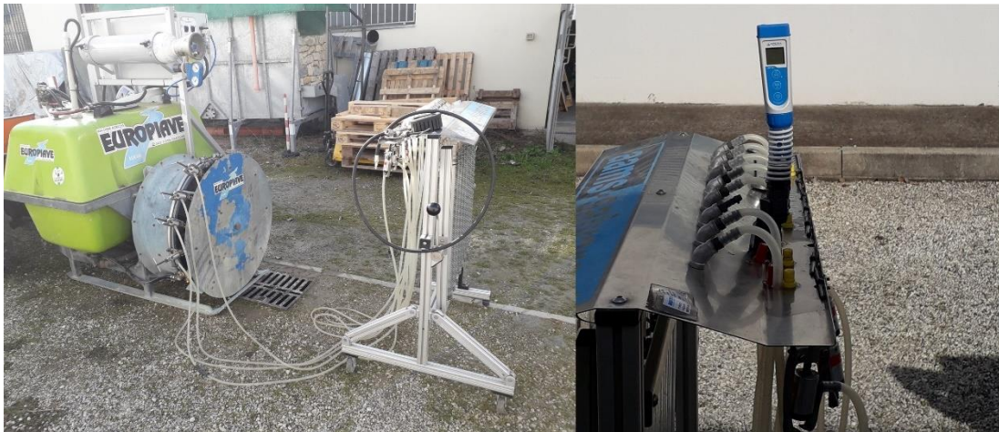
Figura 5.5. Posizione misurazione valore ORP all'uscita degli ugelli
