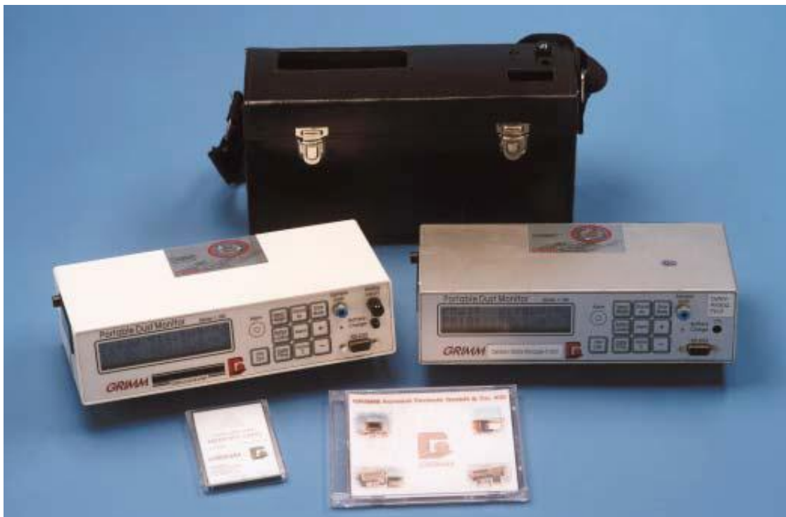
Figura 2.4. OPC, GRIMM modello 1.108 ( www.grimm-aerosol.com )
