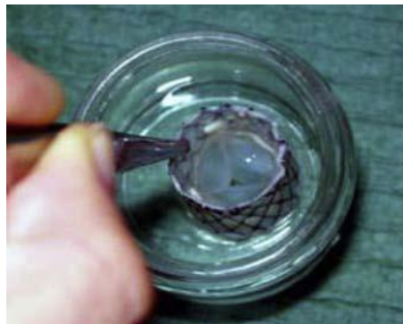
Figura 5.2.11 – l'immagine mostra la valvola che è stata sviluppata utilizzando un tessuto ingegnerizzato applicato su uno stent auto espandibile di nitinol.
