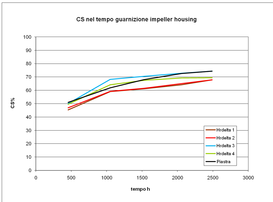
Grafico 5.1 : Confronto tra le guarnizioni Impeller Housing appartenenti ai diversi sistemi e alla precedente campagna in piastra.
