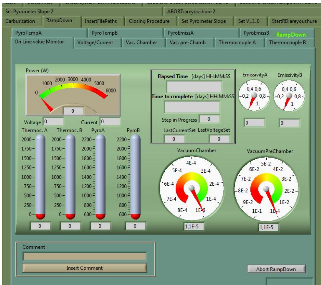
Figura 6-11: Schermata di monitoraggio del processo di ramp-down
