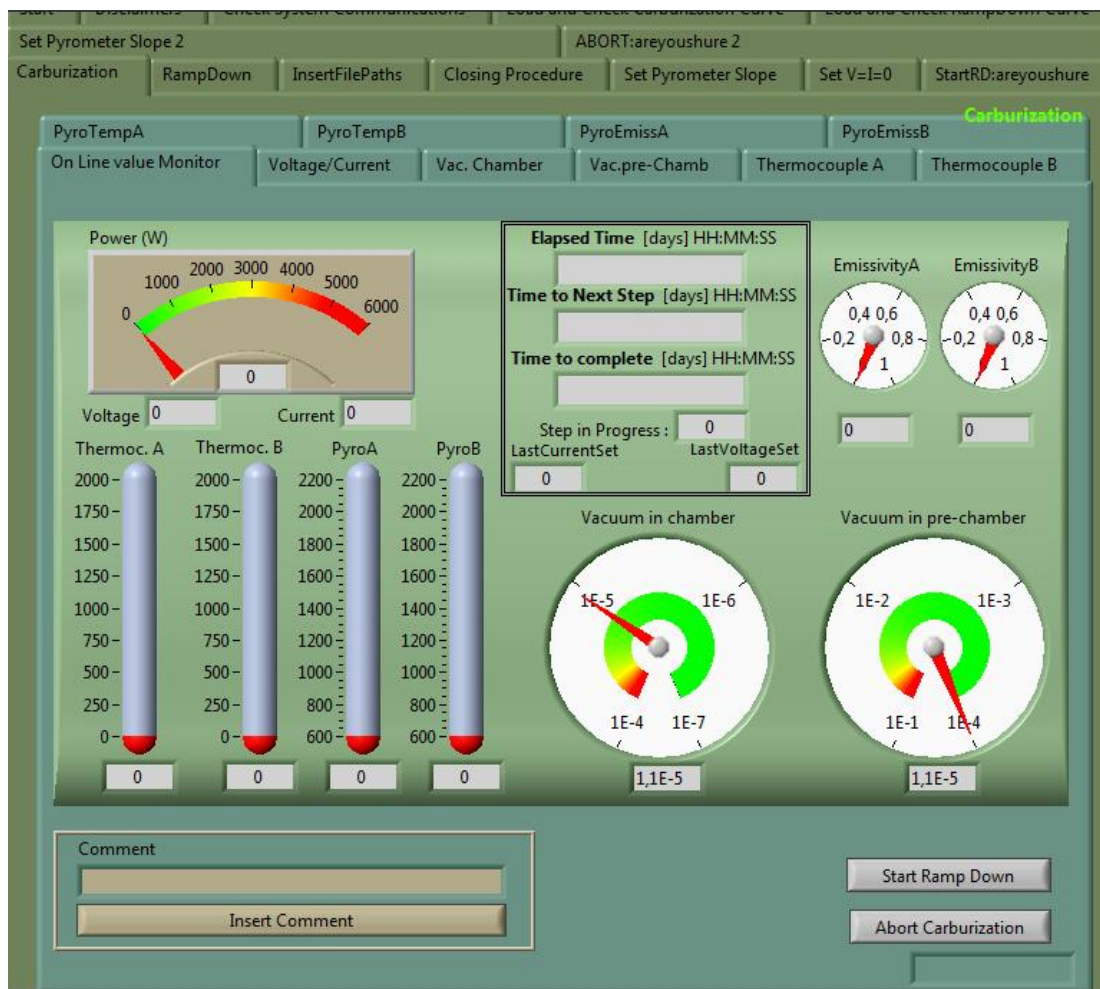
Figura 6-9: Schermata di monitoraggio del processo di carburizzazione
