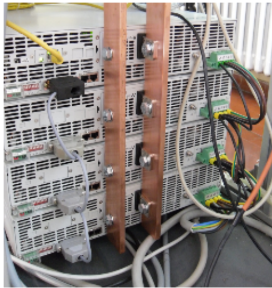
Figura 2-6: Moduli GEN10-330 in configurazione master/slave con uscite di potenza collegate in parallelo
