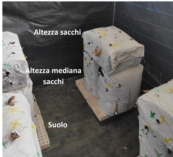
Figura 7: Localizzazione del posizionamento del radiometro "Suolo", "Altezza mediana sacchi", "Altezza sacchi"
