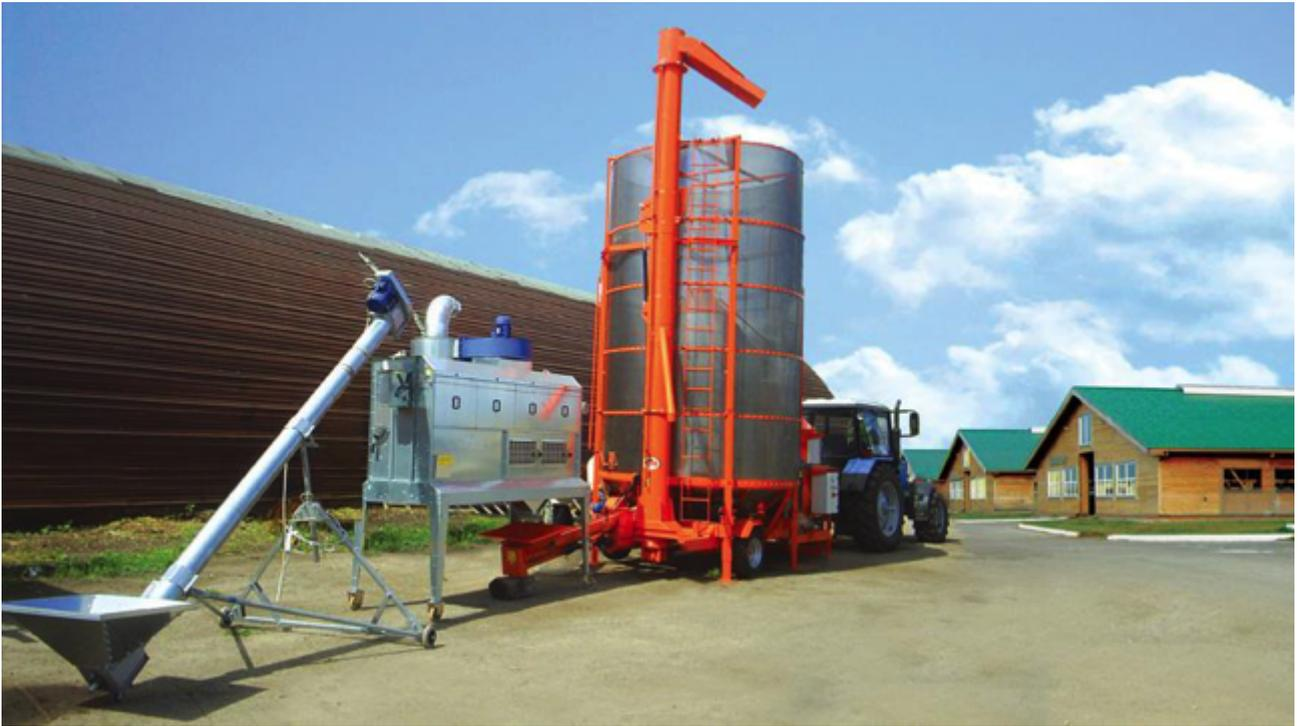
*Fig. Un essiccatoio mobile di capacità 31 m<sup>3</sup> durante la fase di settaggio*
