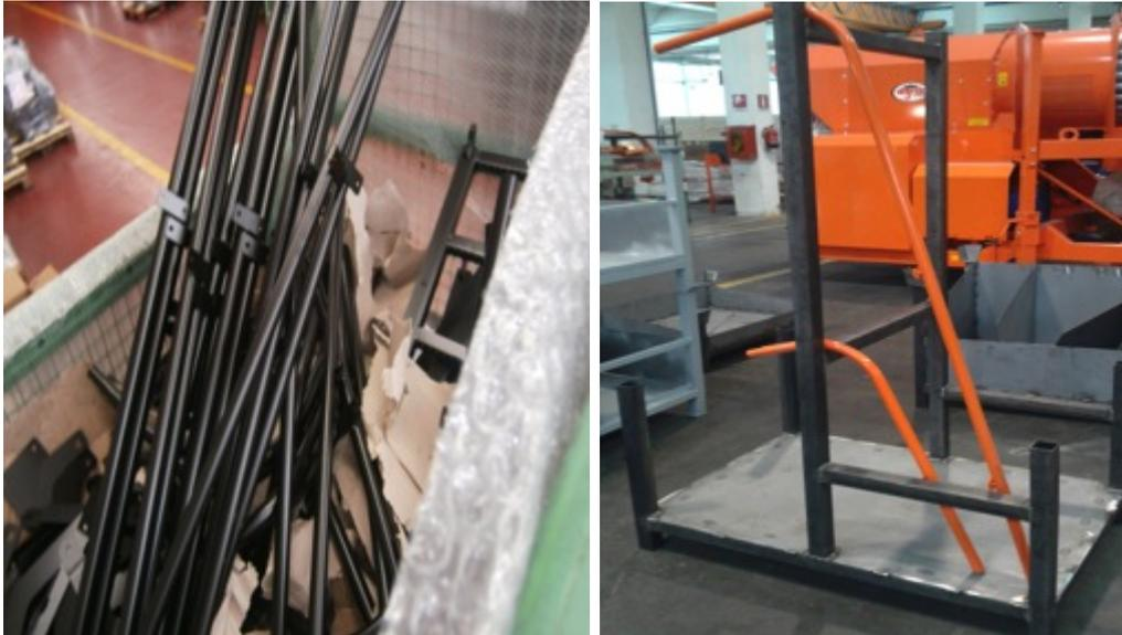
*Fig. Tubi disposti situazione AS IS a sinistra, TO BE a destra*
