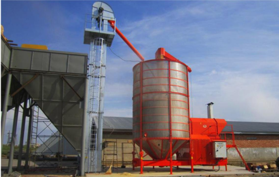
*Fig. Un essiccatoio stazionario di capacità 52 m<sup>3</sup> durante la fase di caricamento dei cereali*
