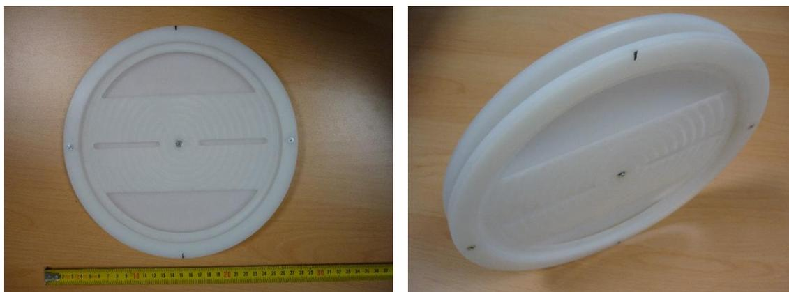
Figura 9.15: Porta-antenna RFID - versione 2
