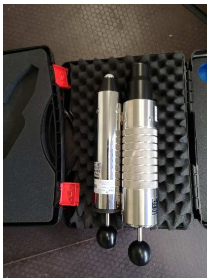
Fig. 1.6 – Martelli a molla con energia di impatto variabile (sinistra) e con energia di impatto fissa (destra)
