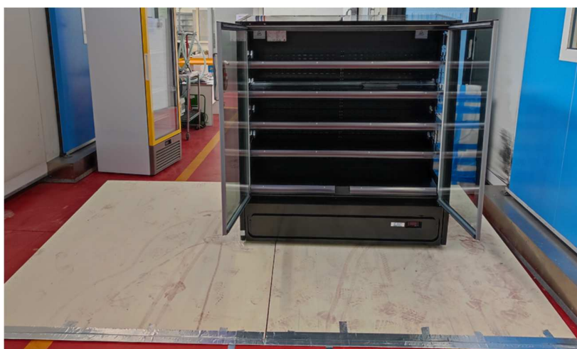
Fig. 1.5 – Rampa con inclinazione di 5°
