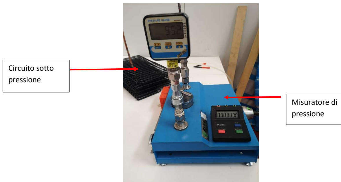
Fig. 1.12 – Strumento di pressurizzazione, test sull'condensatore
