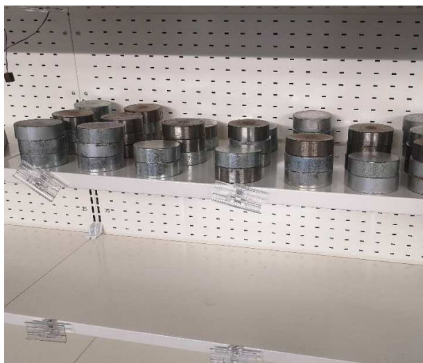
Fig. 1.9 – Prova di carico 230 \text{ kg/m}^2
