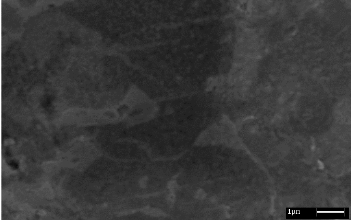
Figura 4.9. Immagine SEM delle nanoparticelle ottenute con un impulso di corrente di -120 mA e della durata di 500 ms. 9000 ingrandimenti.
