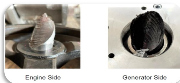
Figura 2.3.3 – Alcuni esempi di fratture su prodotti Mecc Alte
