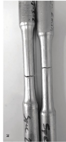
Figura 2.3 Diagramma \sigma/\epsilon e provini arrivati a rottura [5].
