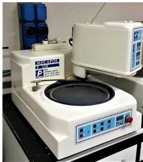
Figura 3.11: Lappatrice utilizzata in laboratorio.
