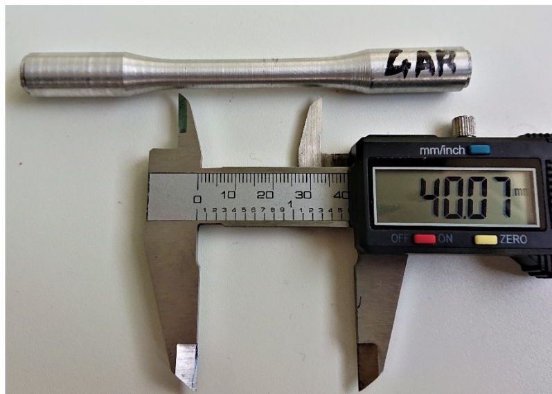
Figura 3.21 Misurazione con calibro dei provini
