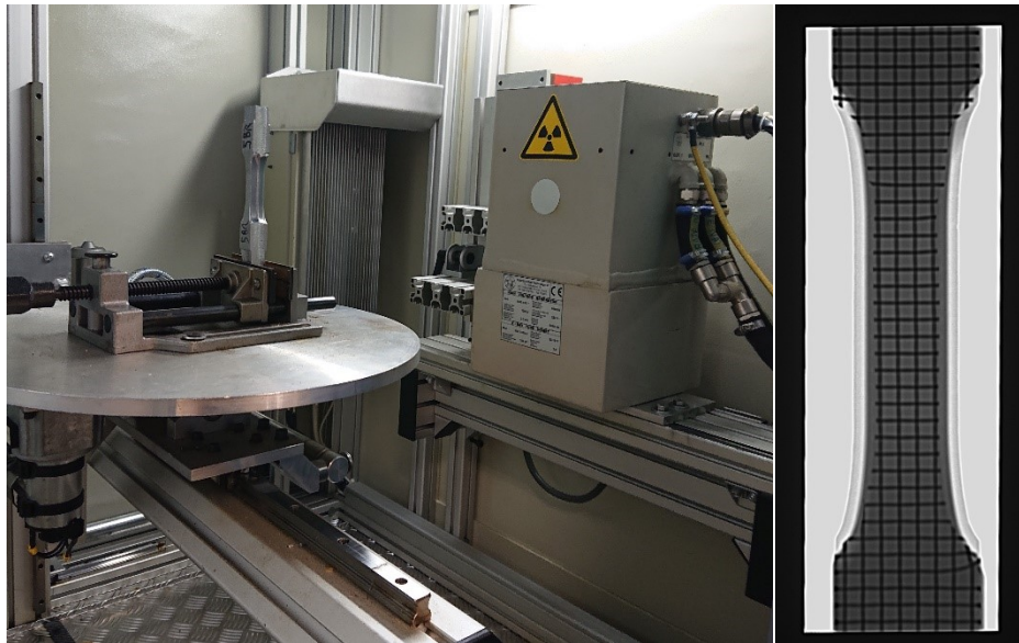
Figura 3.9 Strumentazione raggi X ed esempio di immagine
