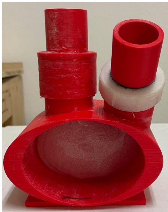
Figura 5.11: Camera ventricolare innovativa inserita e siliconata nello chassis.
