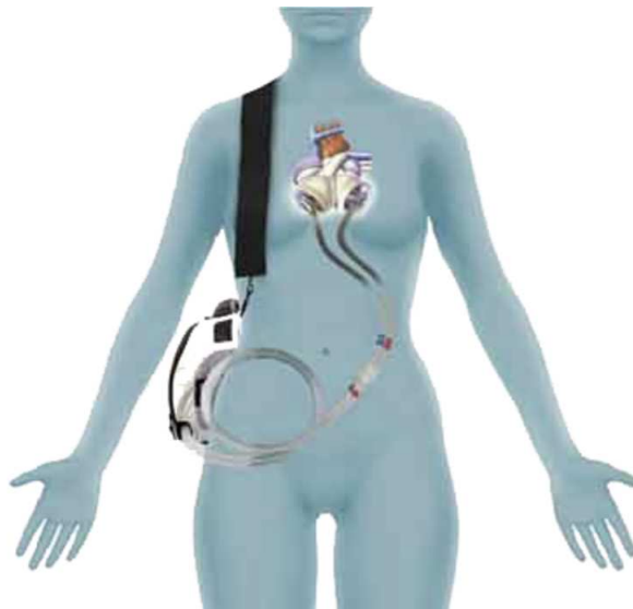
Figura 2.11: Rappresentazione schematica di impianto del dispositivo SynCardia TAH.
