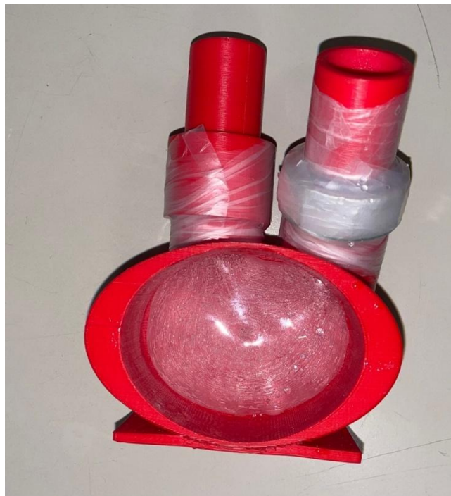
Figura 4.5: Chassis del TAH comprensivo di raccordi di entrata ed uscita ottenuto attraverso la tecnica di stampa FDM.
