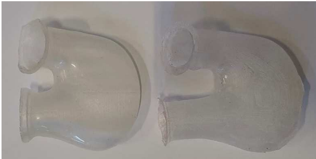
Figura 3.17: A sinistra è riportata la camera ventricolare prodotta secondo le specifiche di progetto; a destra la camera ventricolare con allungamento dei condotti di entrata e uscita per facilitare il montaggio.
