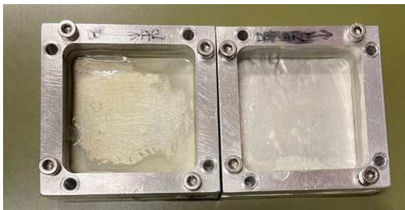
Figura 3.4: Membrana ibrida ottenuta mediante solvent casting .
