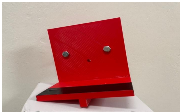
Figura 4.4: Staffa ottenuta con il metodo FDM per il posizionamento solidale del prototipo di TAH con il sostegno d'acciaio dell'attuatore del sistema idraulico per le prove a banco.
