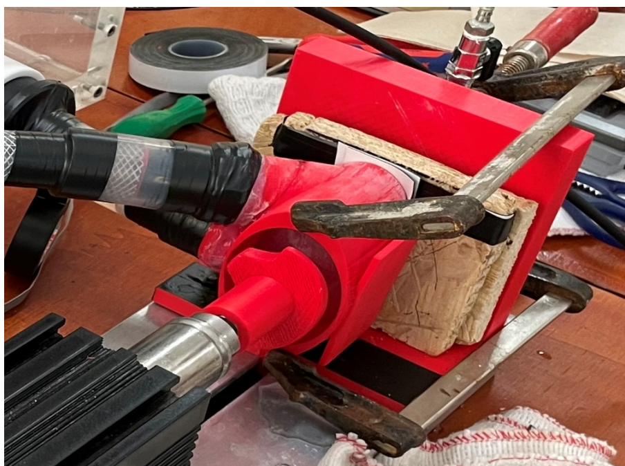
Figura 5.15: Posizionamento del prototipo all'interno del Pulse Duplicator.
