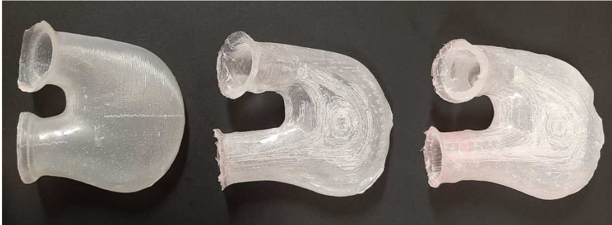
Figura 4.15: Esempi di camere ventricolari realizzate in Cristal Rubber con la tecnica del "dipping" dopo la rimozione dell'anima in PVA.
