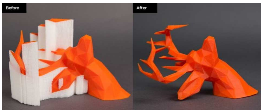
Figura 4.3: A sinistra è mostrato l'oggetto ottenuto mediante stampa 3D con supporti per evitare il rischio di collasso della struttura; a destra vi è l'oggetto dopo la rimozione dei sostegni.
