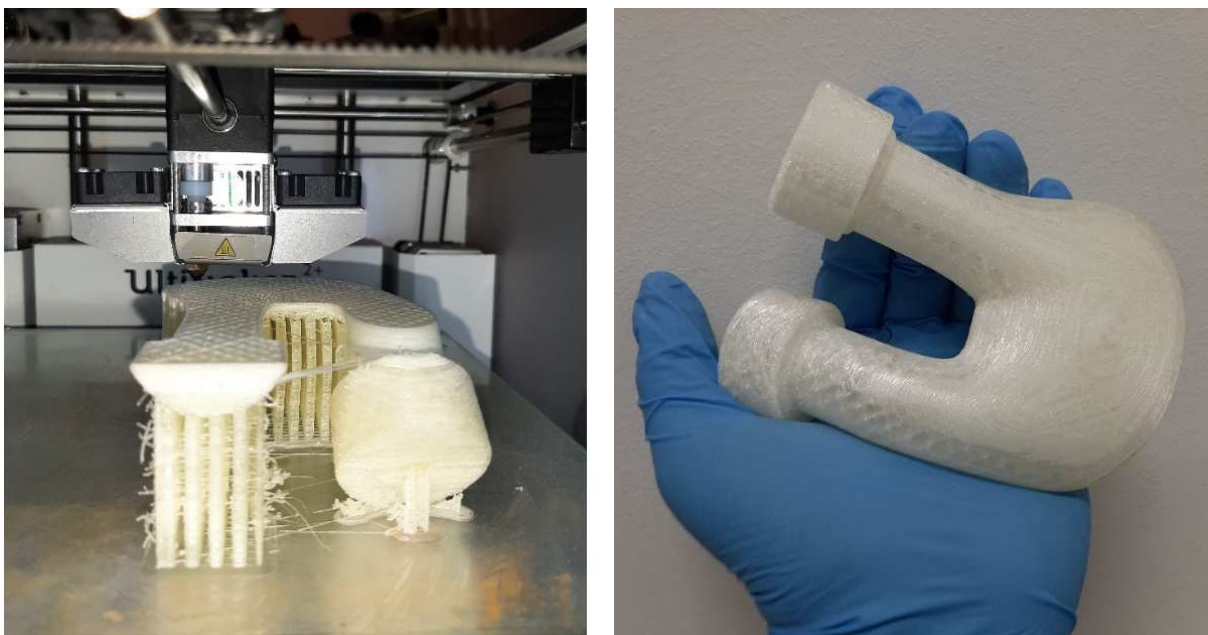
Figura 4.12: A sinistra la stampa 3D dell'anima della camera ventricolare in PVA; a destra l'oggetto finito pronto per effettuare la colata di Cristal Rubber.
