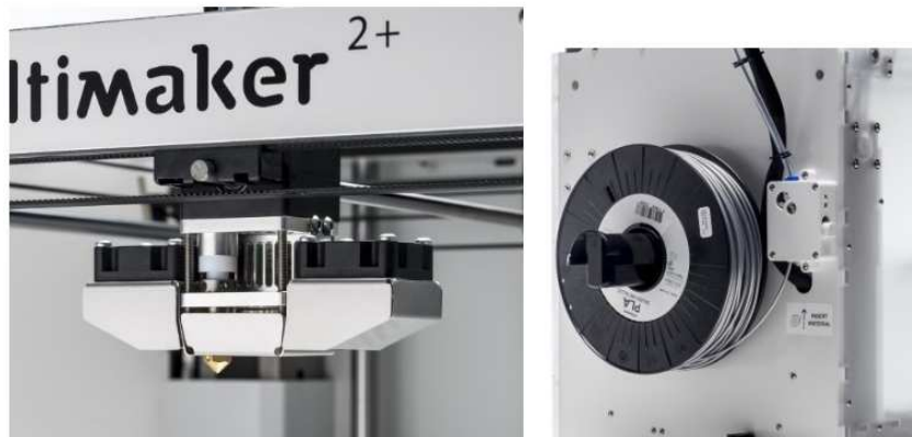
Figura 4.7: A sinistra viene mostrato l'estrusore, dal cui ugello fuoriesce la fibra di polimero fuso per la stampa; a destra è mostrato il vano per la bobina di polimero da stampare, posto posteriormente alla stampante.
