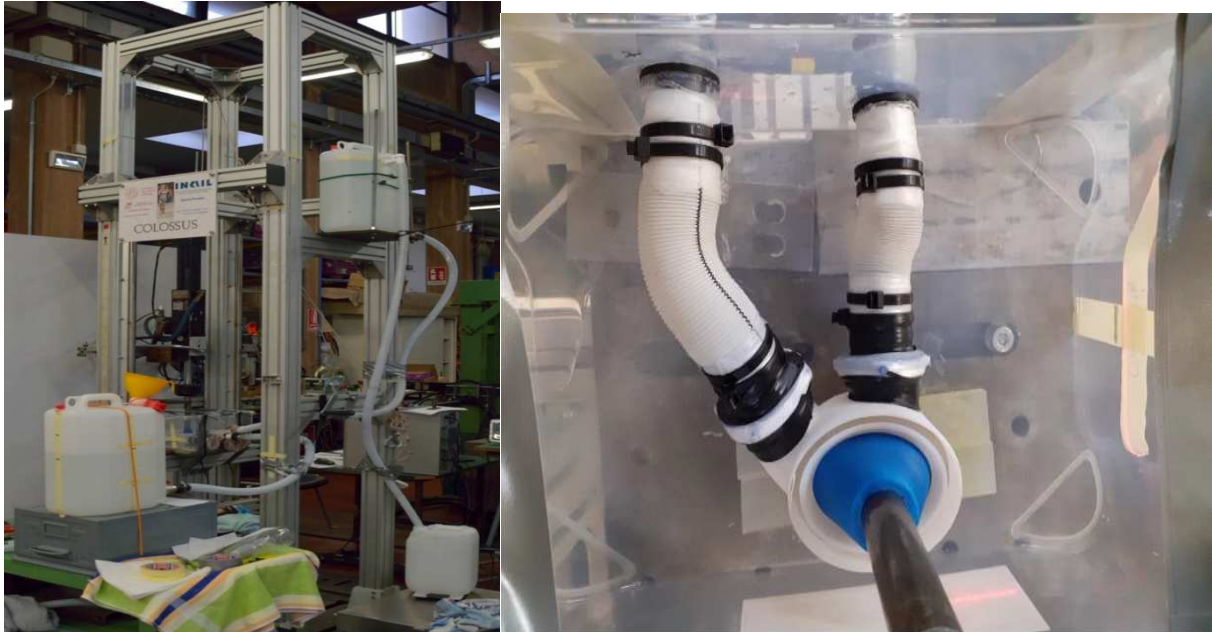
Figura 3.9: A sinistra è riportata la configurazione definitiva delle prove a banco eseguite sul primo prototipo di TAH. A destra invece la configurazione del prototipo con i raccordi alle condotte del sistema idraulico.
