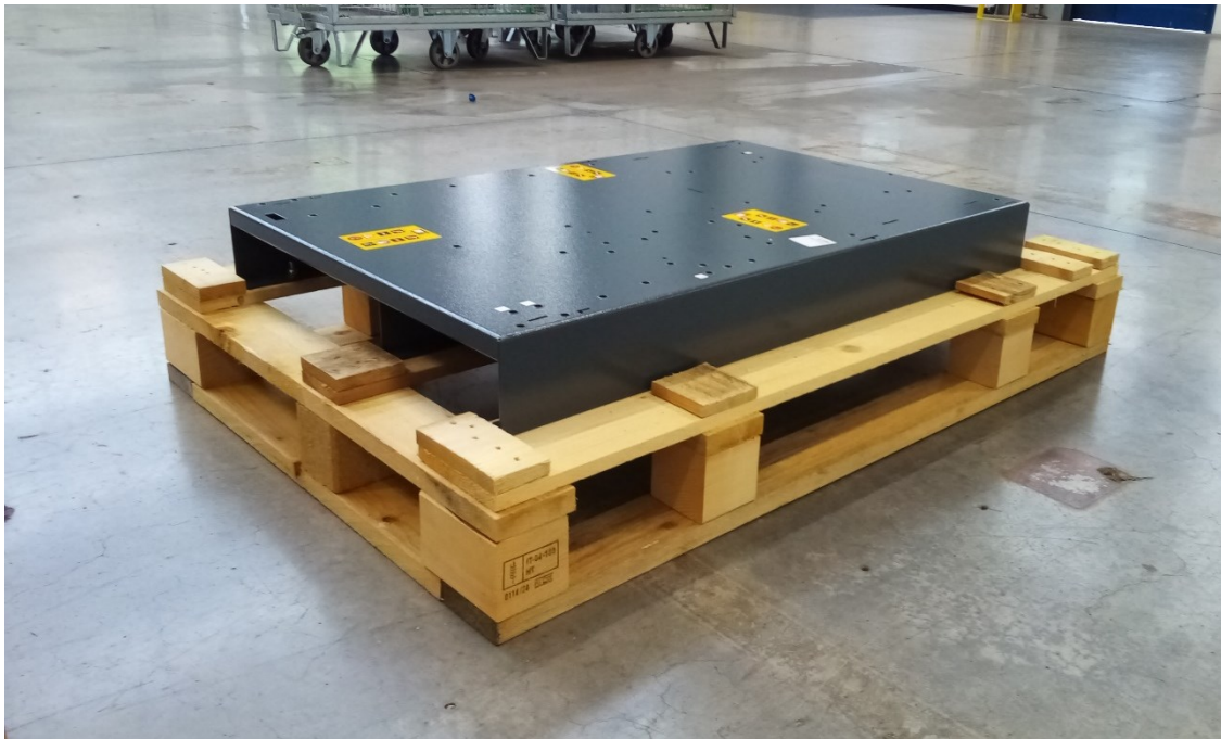
Figura 3.15: Base dei compressori montata sul suo pallet
