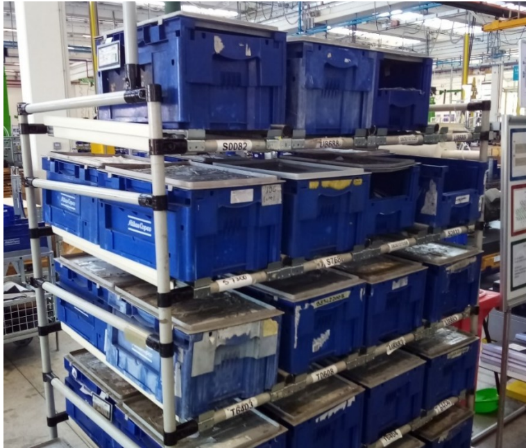
Figura 4.12: Esempio di UdC monocomponente “contenibili” – blue box su flowrack
