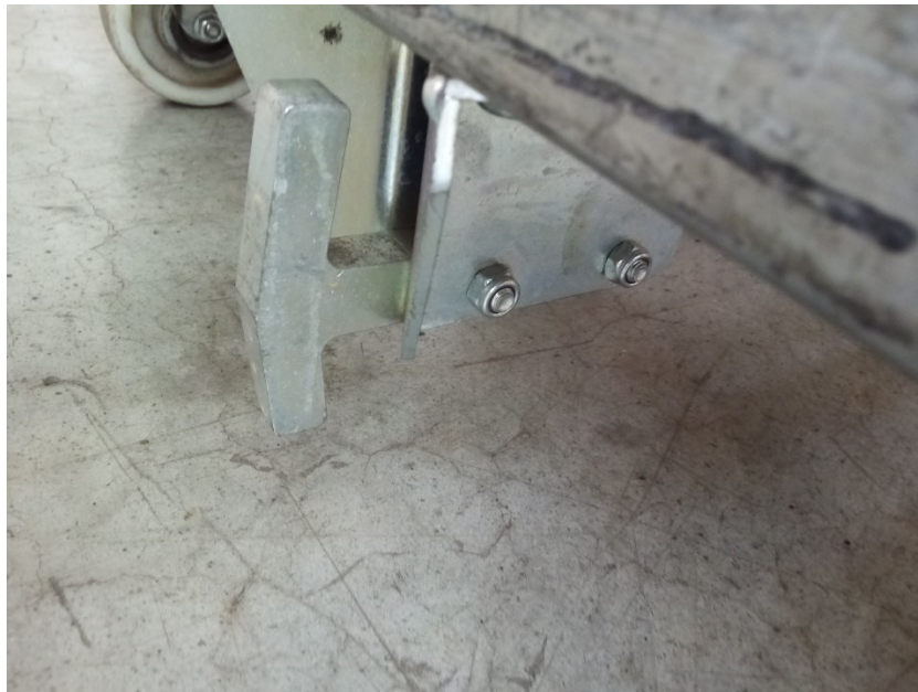
Figura 3.5: Dettaglio del perno attualmente montato sui carrelli
