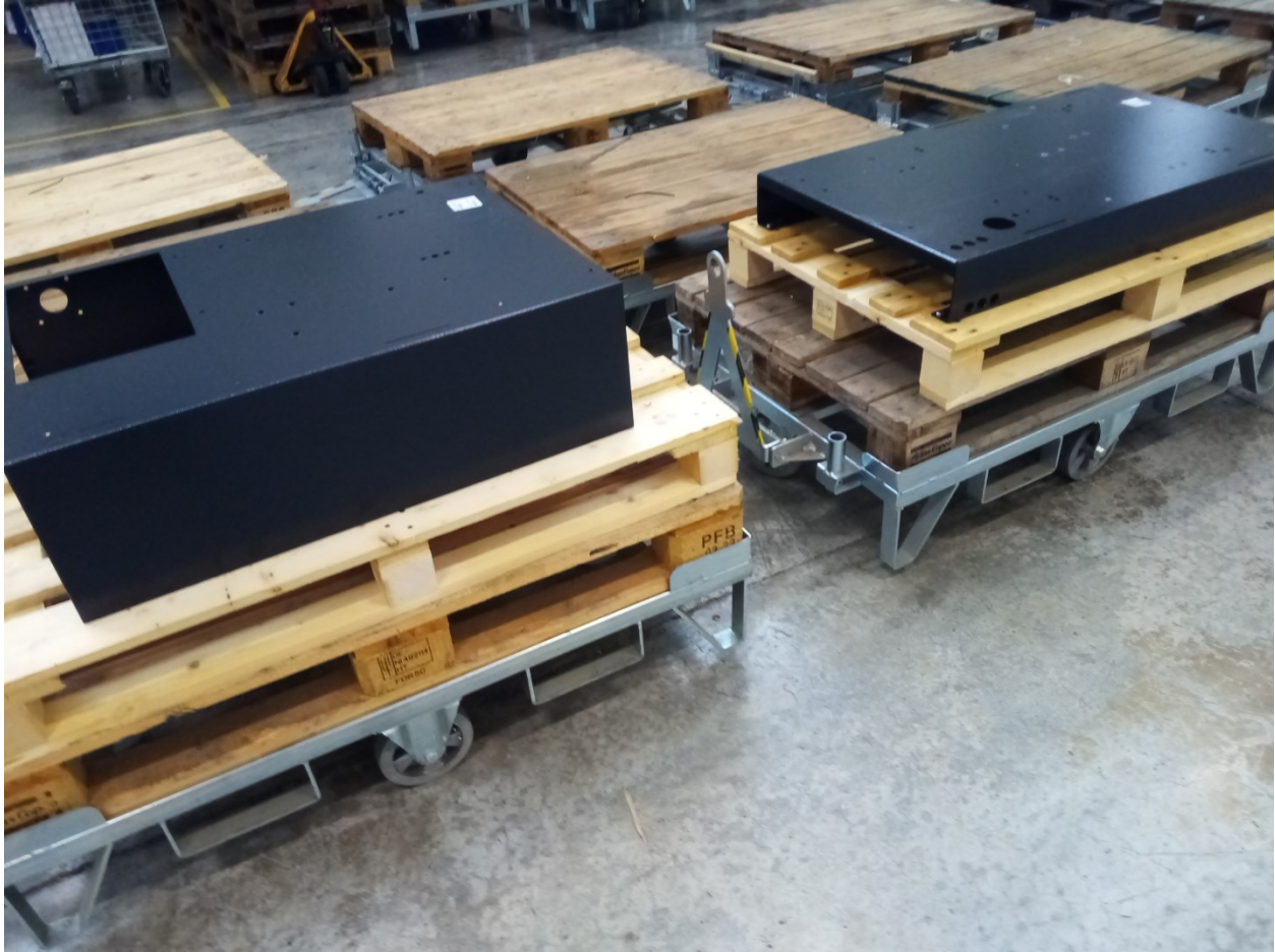
Figura 3.18: Basi per i compressori posizionate su basi carrellate per il tigger train
