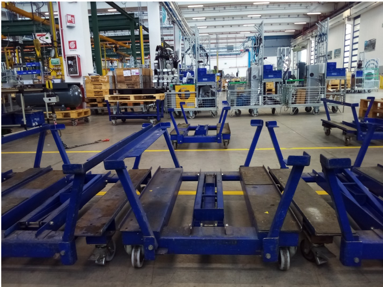
Figura 3.16: Carrelli per l’assemblaggio dei compressori sulle basi
