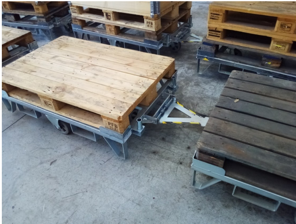
Figura 3.7: Carrelli porta pallet chiamati in azienda “basi carrellate” collegati tra loro
