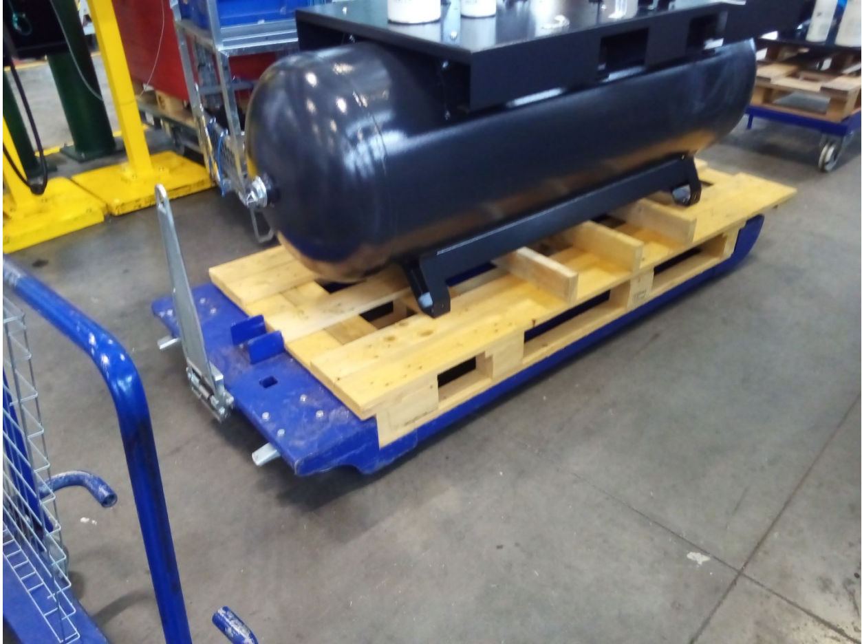
Figura 3.2: Serbatoio per compressore su carrello blu
