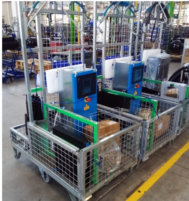
Figura 4.13: Esempio di kit con i componenti per assemblare parte di una macchina
