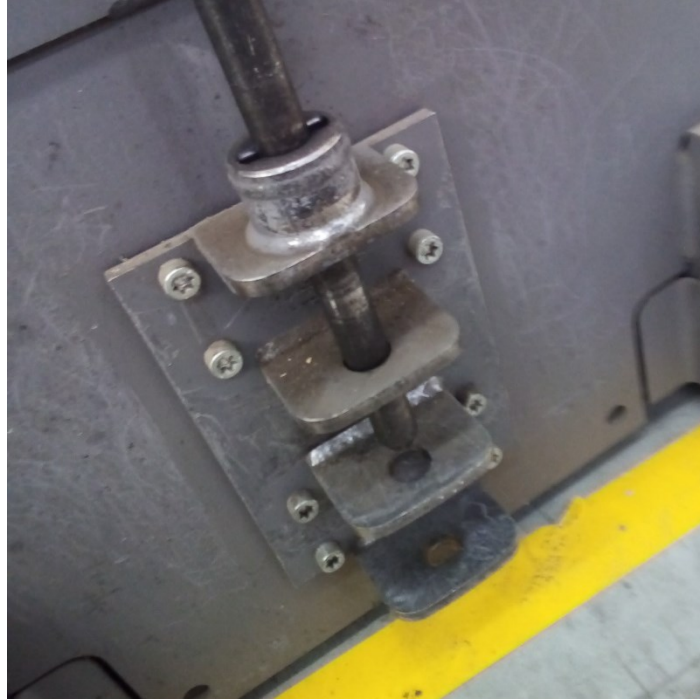
Figura 3.8: Dettaglio dell'aggancio al treno logistico
