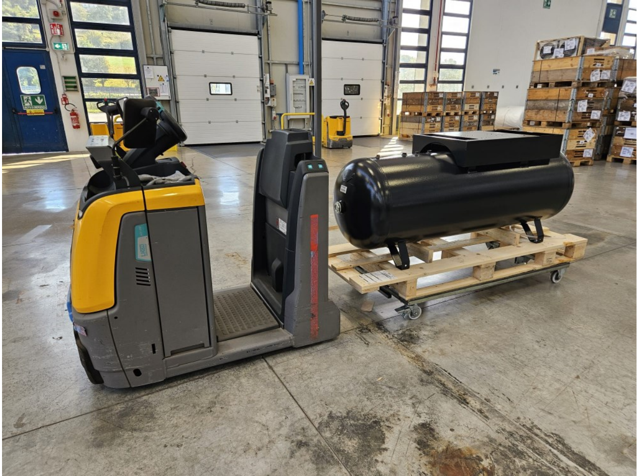
Figura 2.1: Treno logistico utilizzato in Ceccato Aria Compressa
