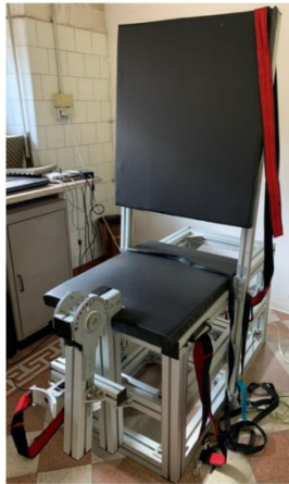
Figura 7: Il dinamometro isometrico utilizzato nello studio durante il protocollo per la valutazione neuromuscolare per misurare la forza volontaria isometrica (massimale e sub-massimale) in estensione di ginocchio, concomitante alla registrazione del segnale HDsEMG.
