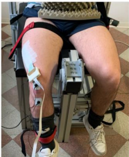
Figura 8: Il set up sperimentale sul dinamometro isometrico e la cella di carico (Kraftaufnehmer Type S9) utilizzata per acquisire il segnale di forza.
