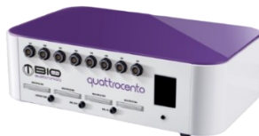
Figura 11: L'amplificatore di segnali bioelettrici con 400 canali utilizzato per amplificare e registrare i segnali elettromiografici di superficie dal muscolo vasto laterale durante l'estensione di ginocchio isometrica.
