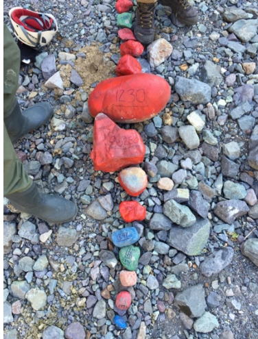
Figura 55: Disposizione dei clasti prima di essere inseriti nell'Estero Morales (monitoraggio 2016).
