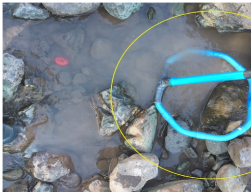
Figura 50: Errore dell'operatore nell'utilizzo dell'antenna – parziale indagine dell'area di studio.
