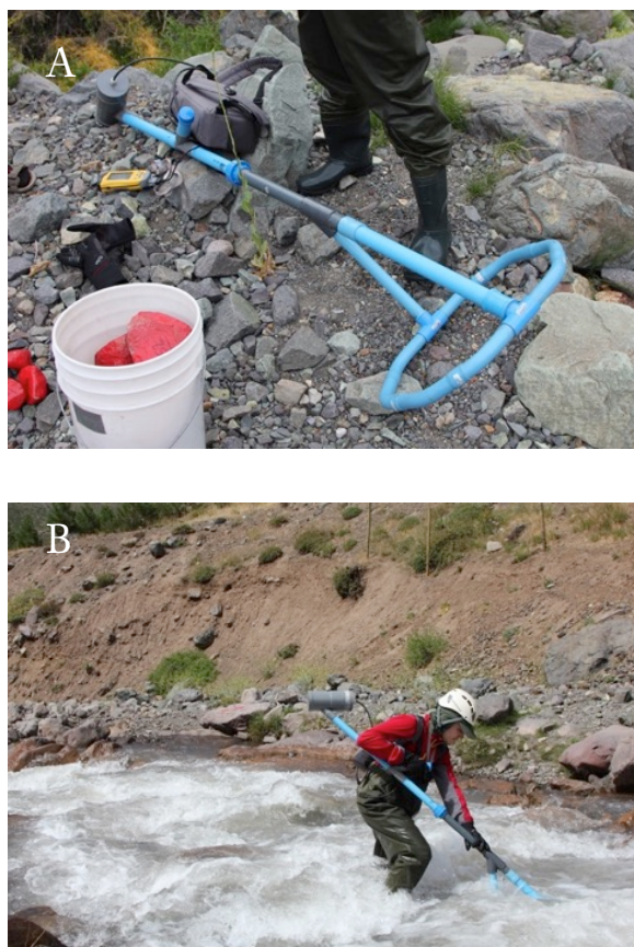
Figura 52: Immagine dell'antenna utilizzata nell'Estero Morales (A); Operazioni di monitoraggio dei PIT nell'Estero Morales (B).
