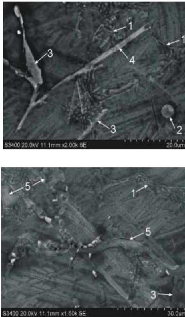
*Figura 2.5 Microstruttura della lega AlSi5Cu1Mg allo stato colato rilevata con microscopio SEM [5]*
