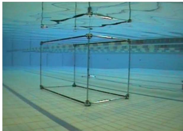
Figura 3.2.1 Griglia utilizzata per la calibrazione estrinseca delle telecamere [4]
