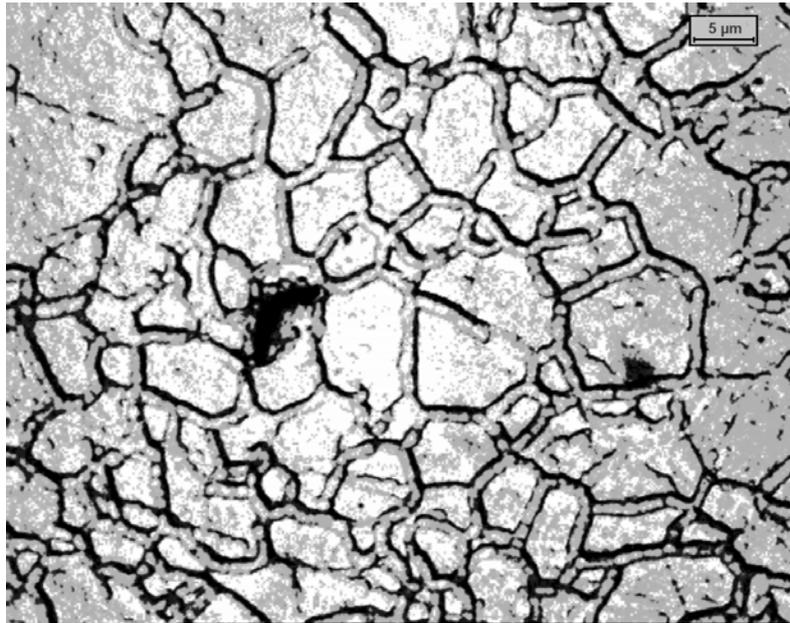
Figura 3.11 Micrografia a 1000x utilizzata per il calcolo della dimensione del grano del campione vergine.
