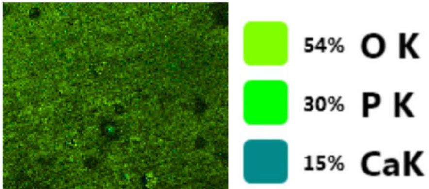
Figura 8.15 Risultati analisi EDS per il campione f=0,1mm/rev oli.
