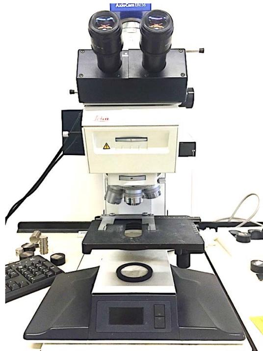
Figura 3.3 Microscopio Ottico utilizzato per le analisi.
