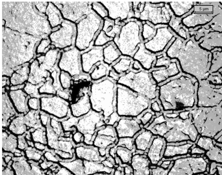
Figura 3.7 Microstruttura AZ31 prima della tornitura, ingrandimento 1000x al microscopio ottico.
