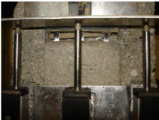
Fig. 5.26 – Esito della prova a taglio diretto su provino DS_CS17_330_60_4.
