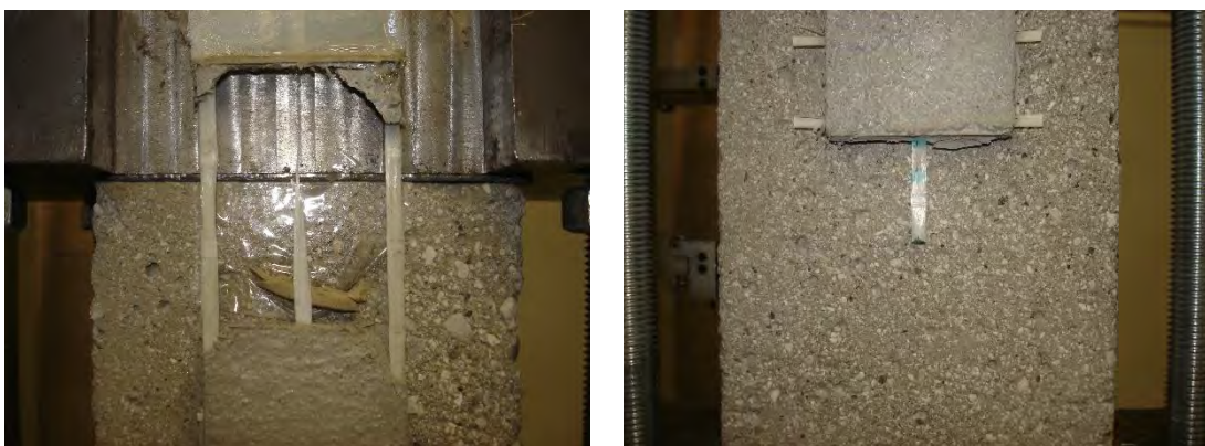
Fig. 5.54 – Esito della prova di taglio diretto sul campione DS_GS25_330_3.
