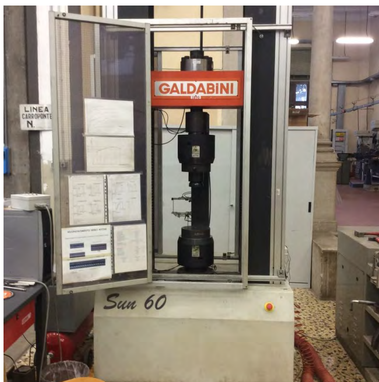
Fig. 5.14 – Macchina universale di prova Galdabini Sun 60
