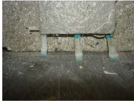
Fig. 5.57 – Esito della prova di taglio diretto sul campione DS_GS25_450_1.
