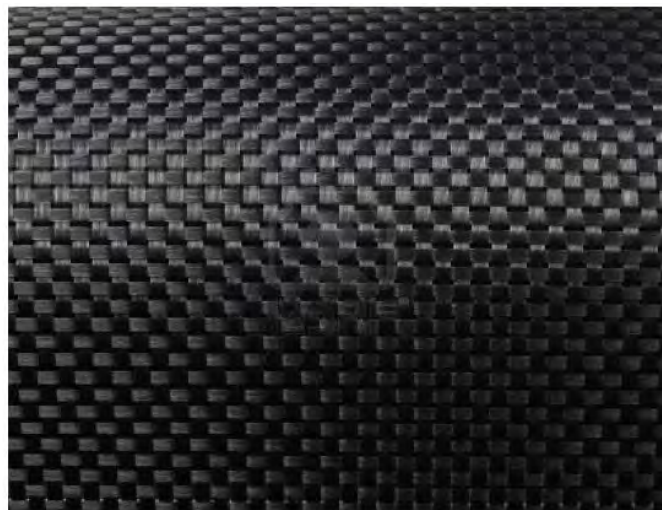
Fig. 2.2 – Esempio di tessuto bidirezionale di fibra di carbonio intrecciata. [9]
