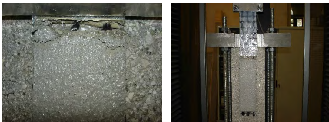
Fig. 5.23 – Esito della prova di taglio diretto sul campione DS_CS17_200_60_3.
