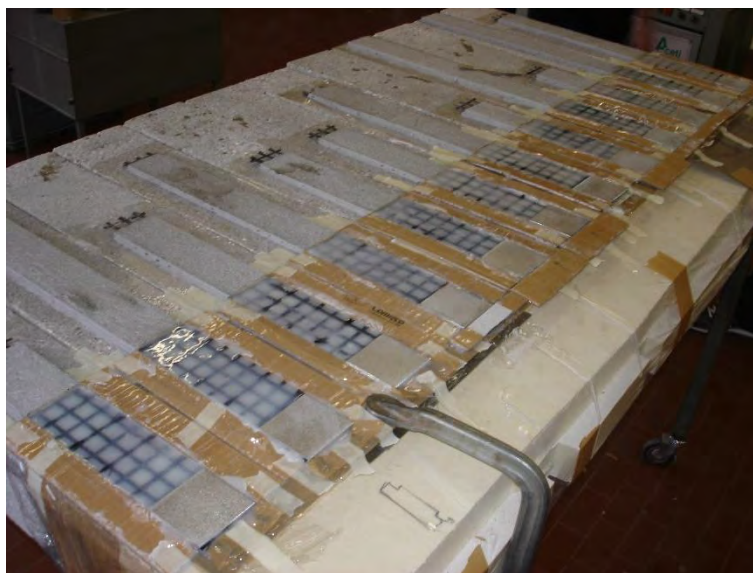
Fig. 5.6 – Impregnazione di resina delle fibre esterne con applicazione di piastrine di alluminio.
