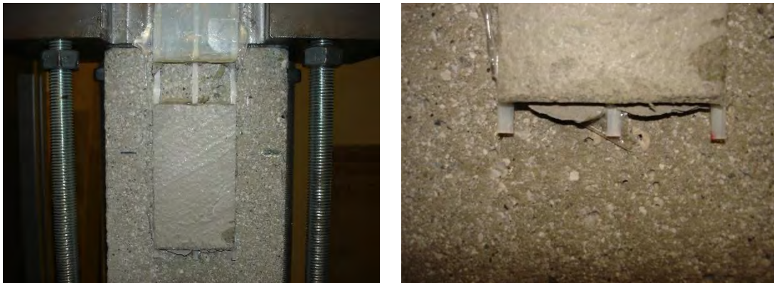
Fig. 5.46 – Esito della prova di taglio diretto su provino DS_GS25_100_55_4.
