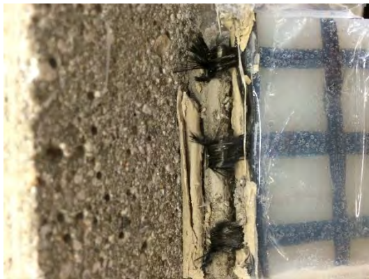
Fig. 5.27 – Particolare di rottura della fibra nel campione DS_CS17_330_60_3.
