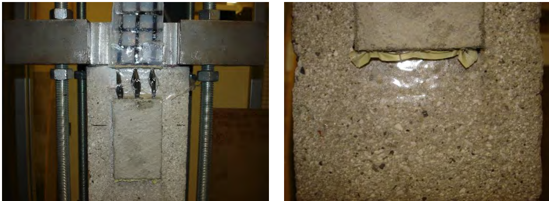
Fig. 5.19 – Esito della prova di taglio diretto per il campione DS_CS17_100_60_2.
