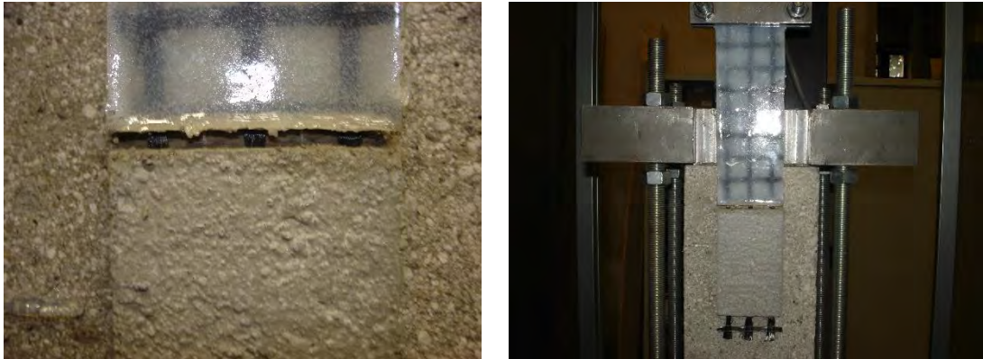
Fig. 5.18 – Esito della prova di taglio diretto per il campione DS_CS17_100_60_1.
