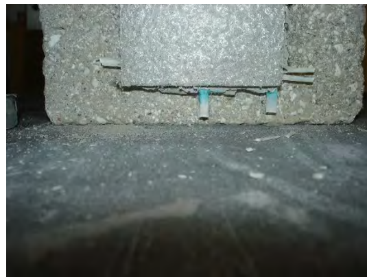
Fig. 5.58 – Esito della prova di taglio diretto sul campione DS_GS25_450_2.
