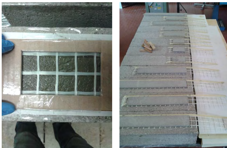
Fig. 5.7 – Vista della rete G-NET 251 BA prima della stesura del secondo strato e campioni pronti per la resinatura della fibra esterna.
