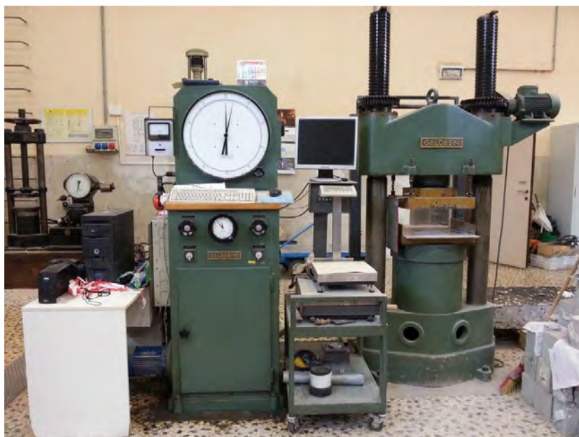
Fig. 4.1 – Macchina universale elettromeccanica Galdabini. [9]
