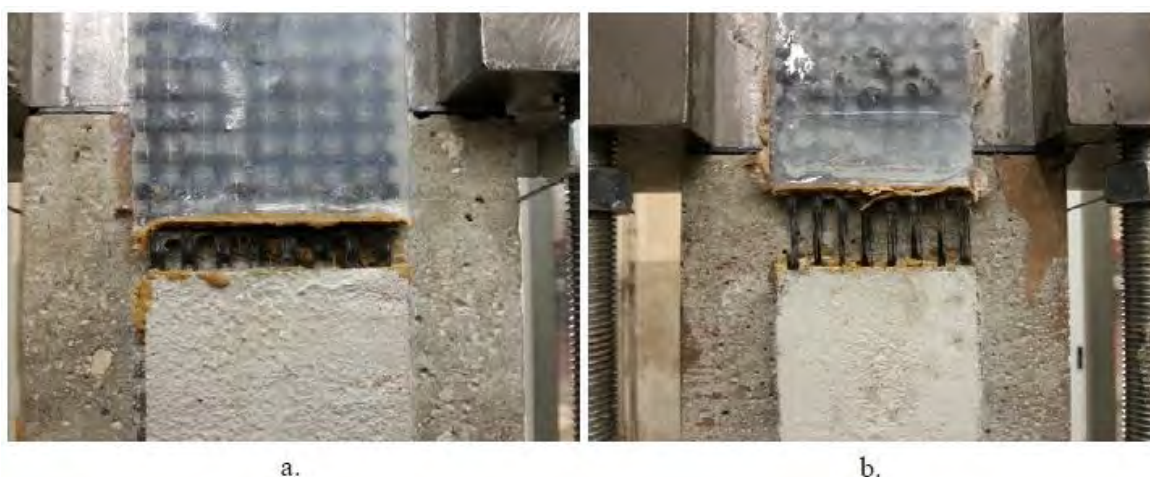
Fig. 3.13 – a) Scorrimento delle fibre nei campioni DS_CW_330_60_3; b) Stiramento delle fibre all'interfaccia tra matrice cementizia e resina epossidica nel campione DS_CW_330_60_1.
