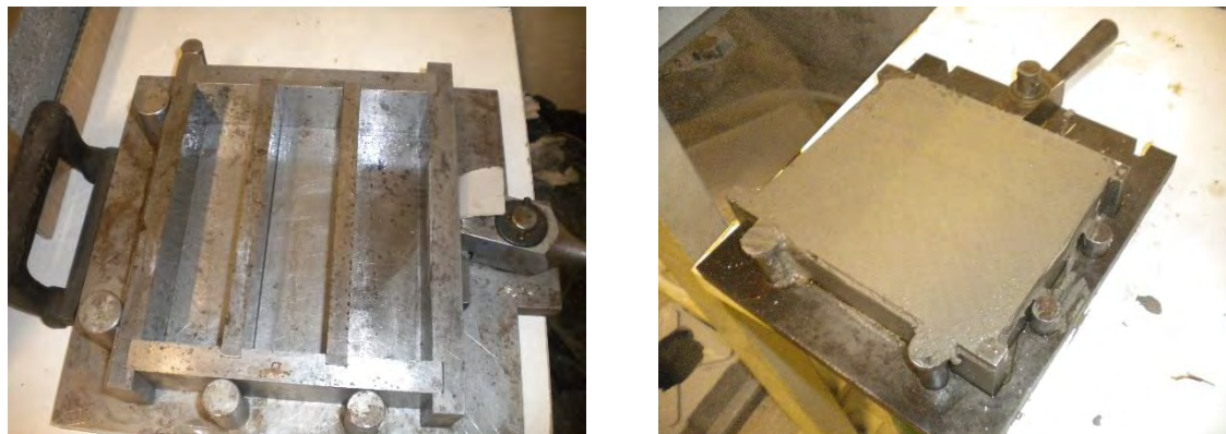
Fig. 4.4 – Cassero per confezionamento di tre provini di malta delle dimensioni di 40x40x160 mm.
