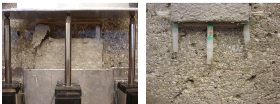
Fig. 5.52 – Esito della prova di taglio diretto sul campione DS_GS25_330_1.
