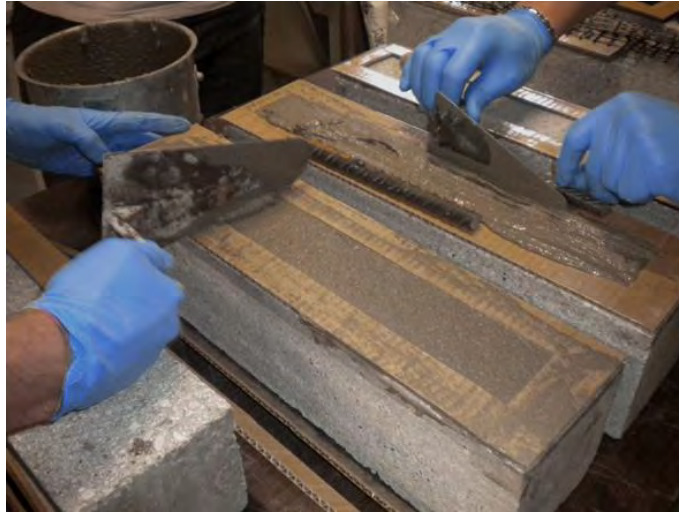
Fig. 5.2 – Stesura primo strato di matrice all'interno del cassero inferiore, aderente al prisma.
