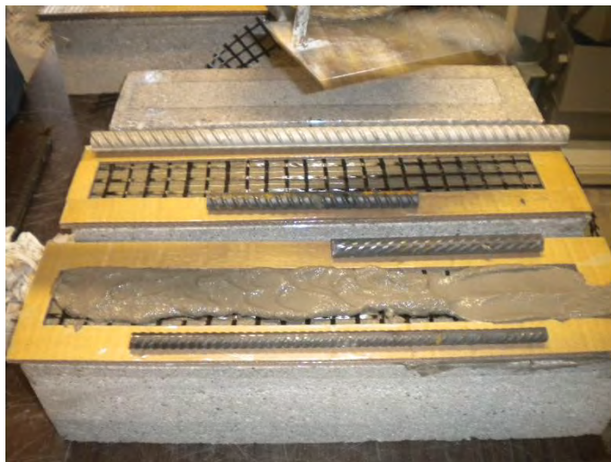
Fig. 5.4 – Applicazione del secondo strato di matrice Rock S all'interno del secondo cassero superiore alla fibra C-NET 170 BL.
