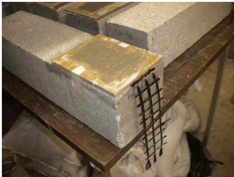
Fig. 5.5 – Applicazione composito FRCM completata, campione DS_CS17_100_60_2.
