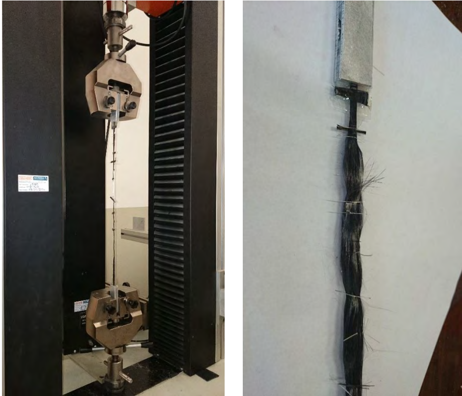
Fig. 4.9 – Prova a trazione C-NET 170 BL; esito della prova a trazione C-NET 170 BL: particolare della fibra rotta.
