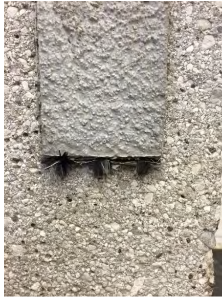
Fig. 5.25 – Esito prova di taglio diretto sul campione DS_CS17_330_60_2.
