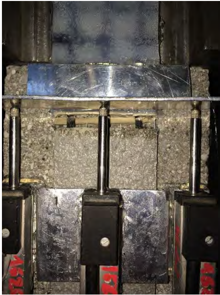
Fig. 5.25 – Esito prova di taglio diretto sul campione DS_CS17_330_60_2.
