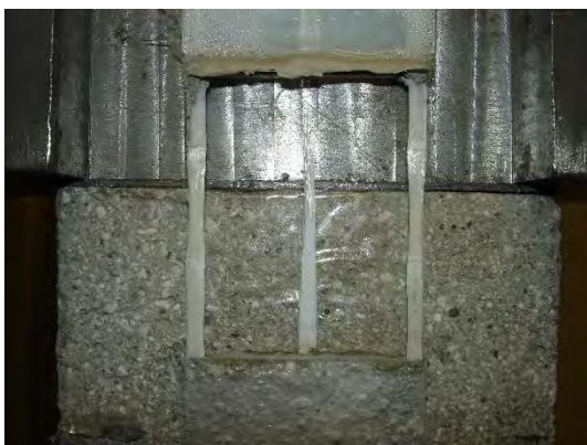
Fig. 5.59 – Esito della prova di taglio diretto sul campione DS_GS25_450_3.
