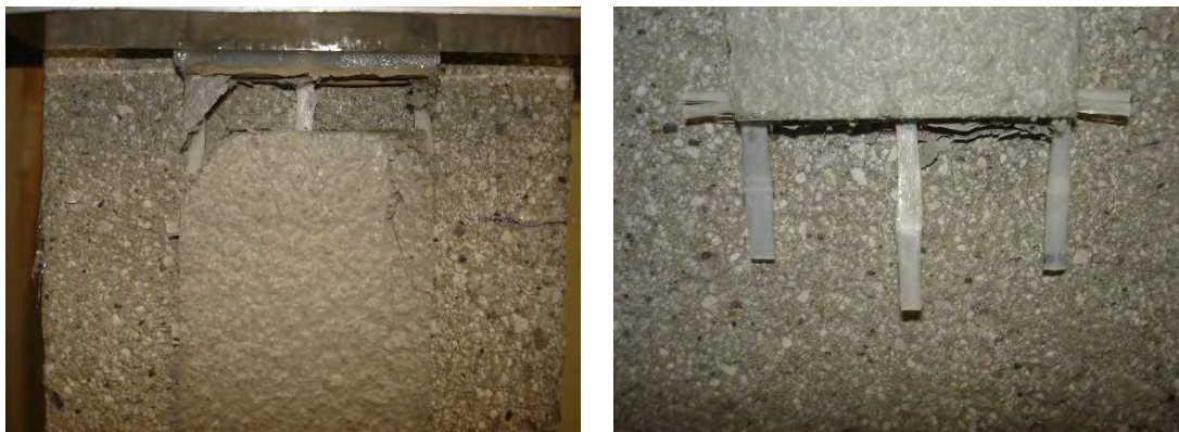
Fig. 5.48 – Esito della prova a taglio diretto sul campione DS_GS25_200_55_2.
