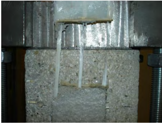
Fig. 5.57 – Esito della prova di taglio diretto sul campione DS_GS25_450_1.
