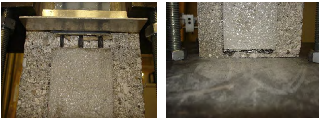
Fig. 5.31 – Esito della prova a taglio diretto sul campione DS_CS17_450_60_3, particolare delle fibre.
