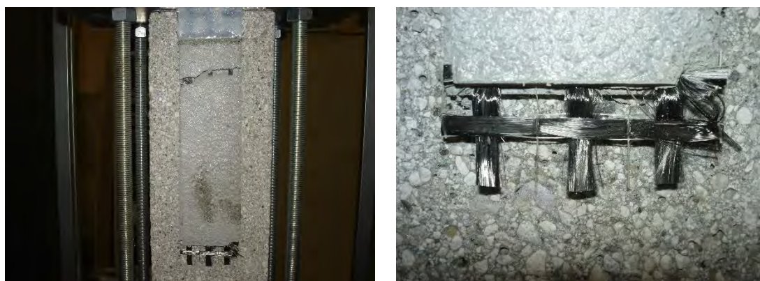
Fig. 5.21 – Esito della prova di taglio diretto sul campione DS_CS17_200_60_1.
