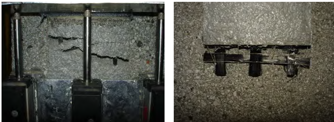
Fig. 5.22 – Esito della pro di taglio diretto sul campione DS_CS17_200_60_2.
