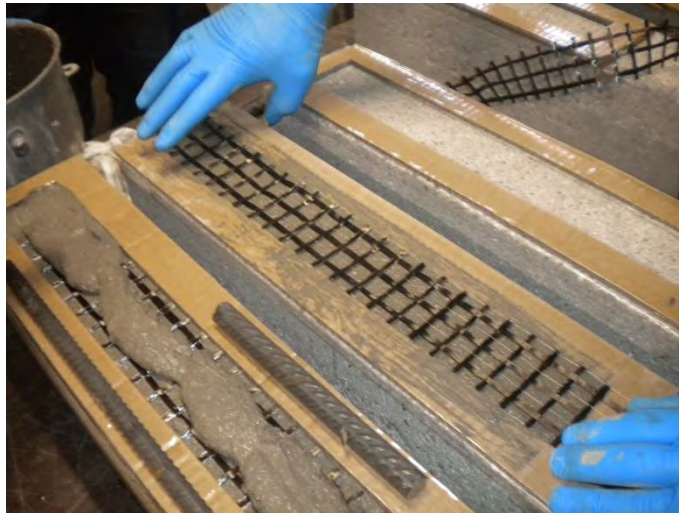
Fig. 5.3 – Applicazione della fibra C-NET 170 BL con leggera pressione.
