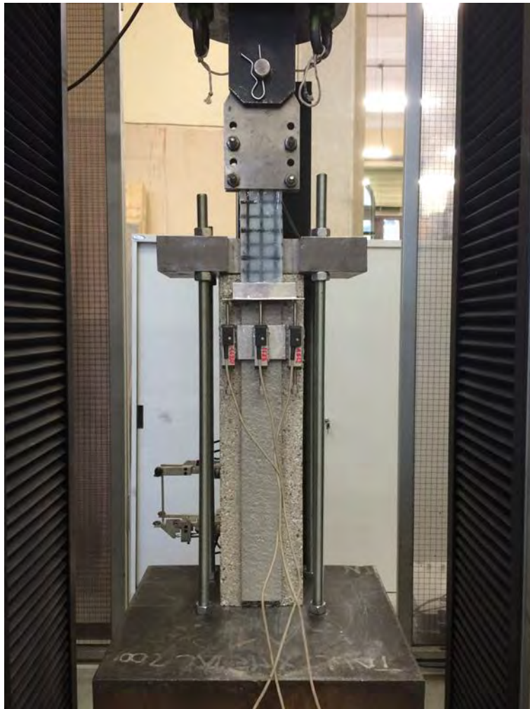
Fig. 5.16 – Foto set-up per la prova di taglio diretto,
