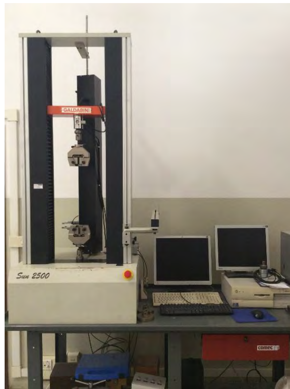
Fig. 4.6 – Macchina universale Galdabini 2500 per prove di trazione.
