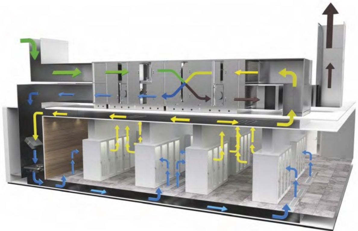
Figura 4.2 Schema di funzionamento del free cooling indiretto.
