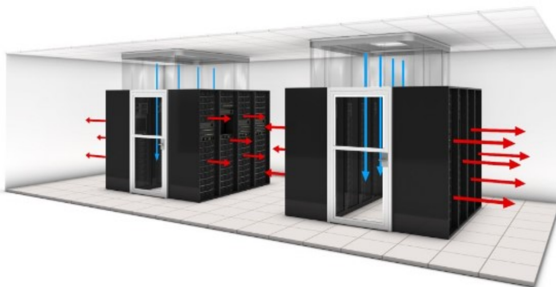
Figura 5.2 Esempio contenimento del flusso di aria fredda
