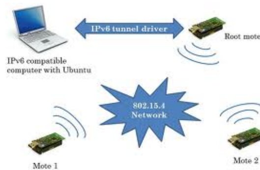
Figura 4.5: Un'astrazione funzionale del serial tunneling .
