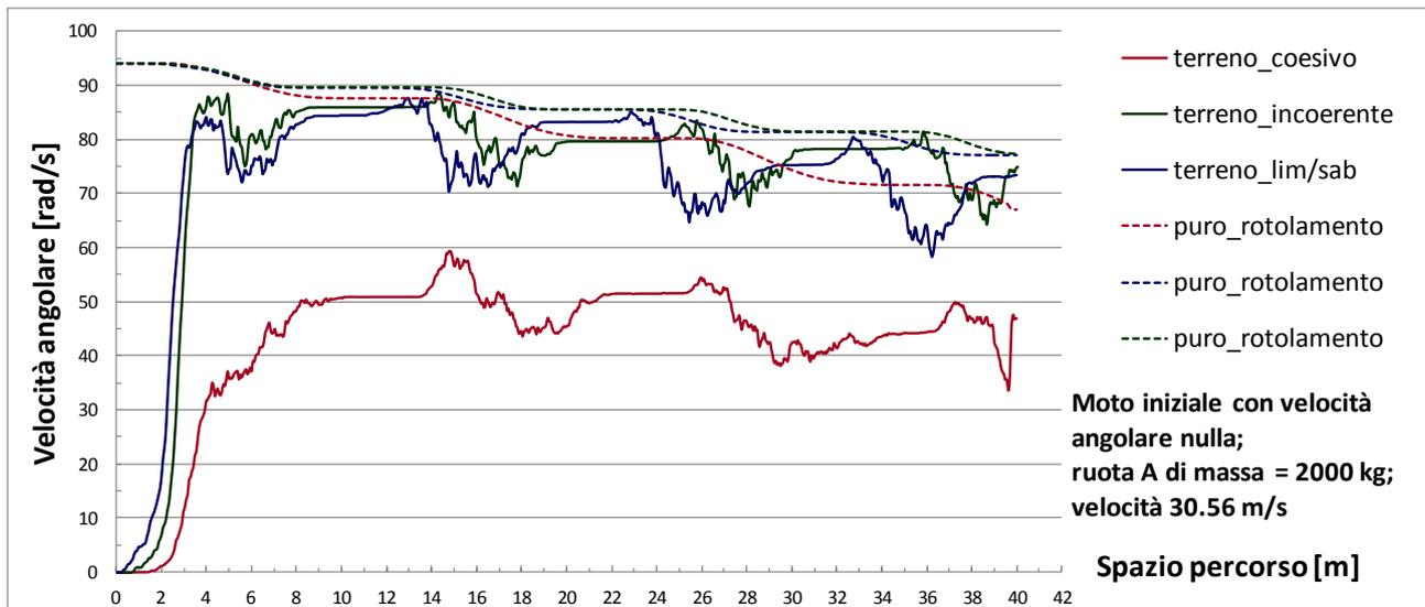
Figura 43 Andamenti delle velocità angolari per la ruota A nel caso di moto iniziale di pattinamento puro ( $v_x = 30.56$  m/s) e velocità angolari di puro rotolamento
