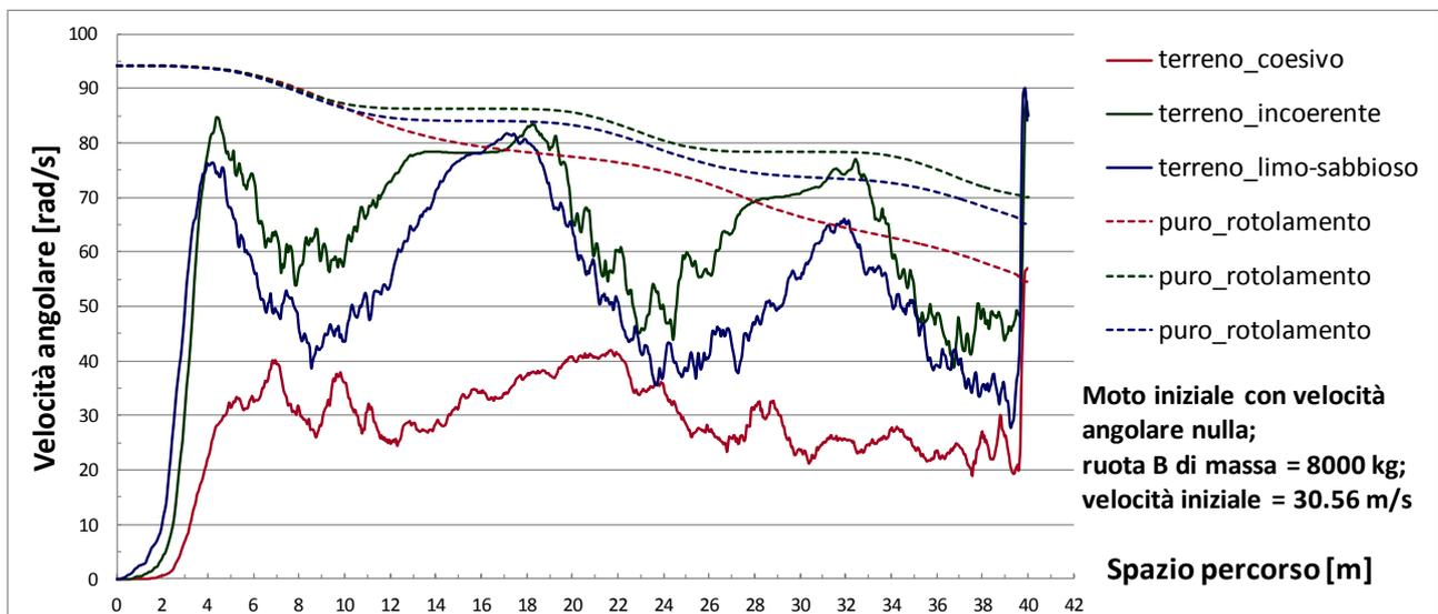
Figura 44 Andamenti delle velocità angolari per la ruota B nel caso di moto iniziale di pattinamento puro ( $v_x = 30.56$  m/s) e velocità angolari di puro rotolamento
