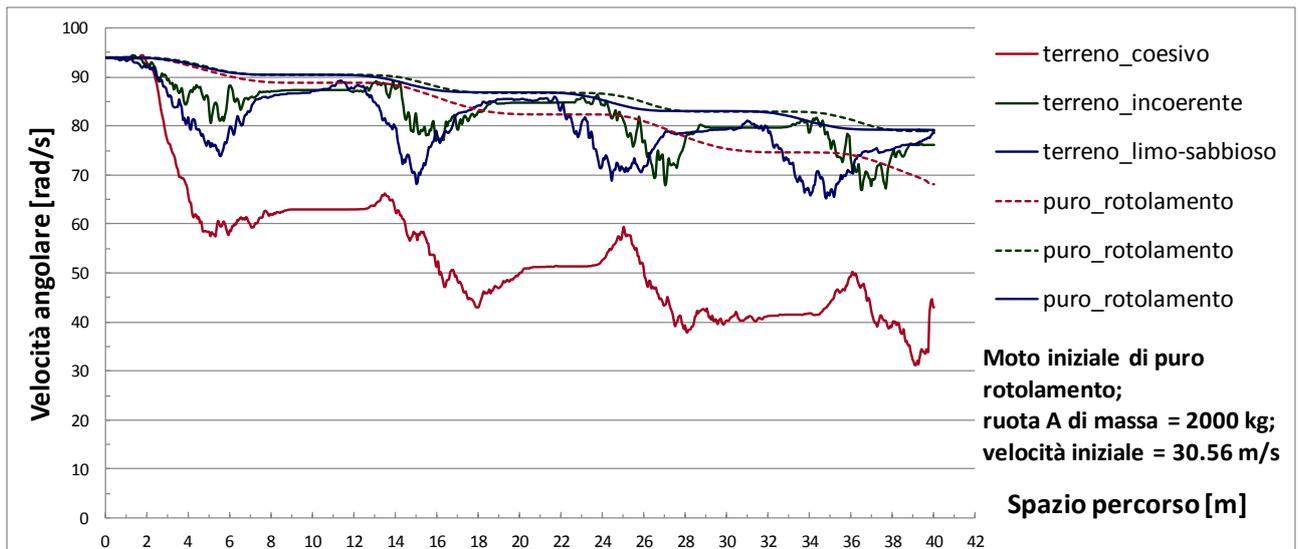
Figura 27 Andamenti delle velocità angolari per la ruota A nel caso di moto iniziale di puro rotolamento ( $v_x = 30.56$  m/s) e velocità angolari di puro rotolamento
