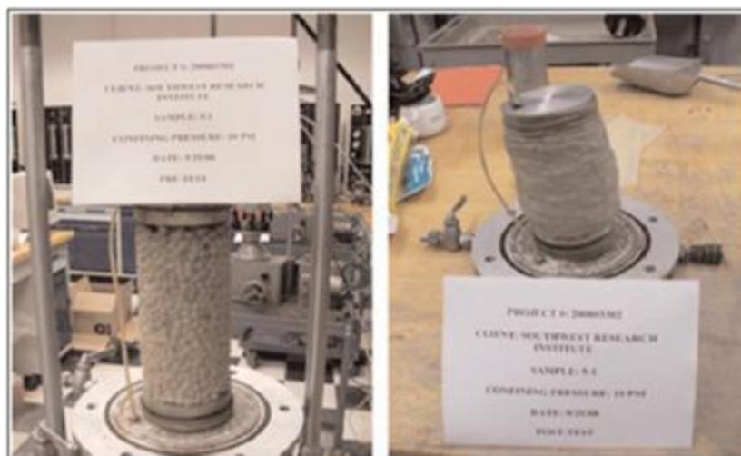
*Figura 1.9 Prove triassiali su provini di aggregato di tipo ingegneristico [1]*
