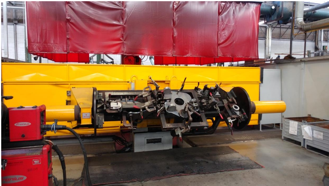
Figura 3.5 Robot 89.51 con montata una maschera e dei pezzi
