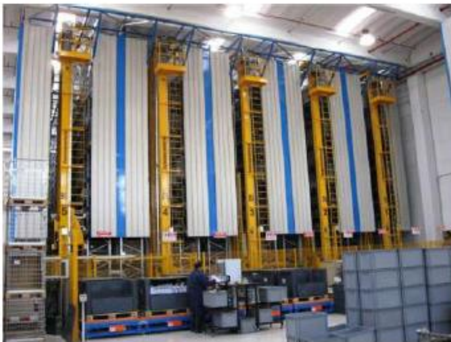
Figura 2.14 Esempio di magazzino non autoportante [5]
