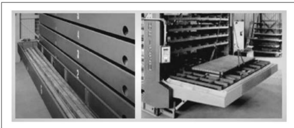
Figura 2.11 Magazzino automatico a contenitori per barre e lamiere [4]
