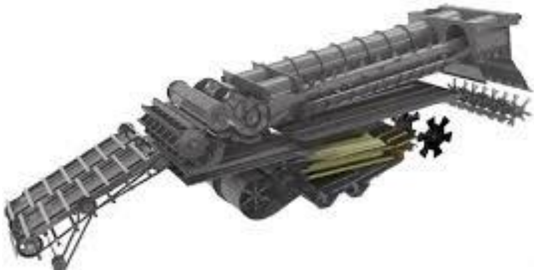
Figura 1.18 Tecnologia di trebbiatura ibrida [2]
