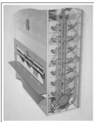
Figura 2.10 Magazzino verticale traslante [4]
