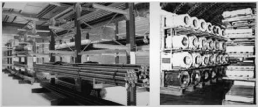
Figura 2.12 Esempi di impieghi delle scaffalature cantilever per barre e bobine [4]
