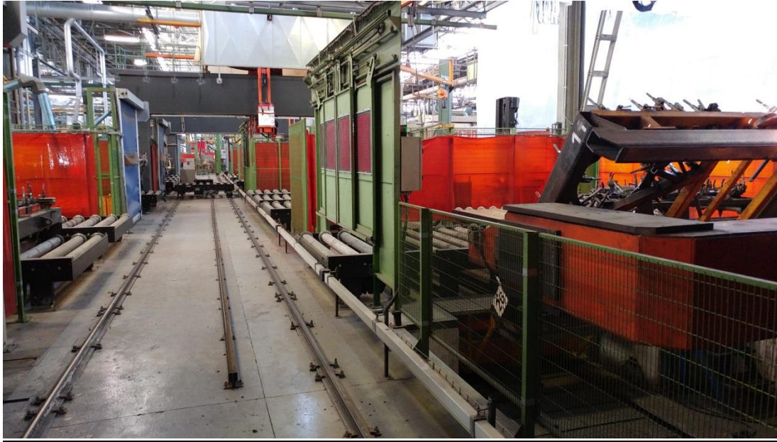
Figura 3.14 Sistema FMS si noti la navetta centrale, il pallet in lavorazione sulla destra e le diverse postazioni-buffer per i pallet
