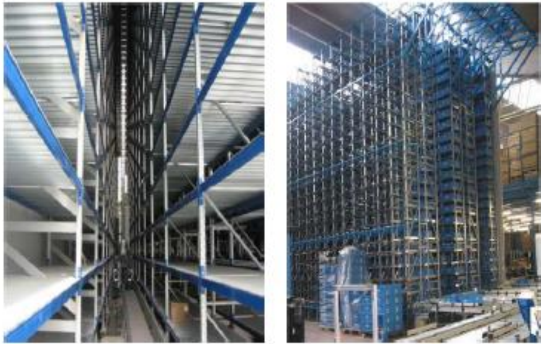
Figura 2.16 Esempio di magazzino miniload per cassette [5]
