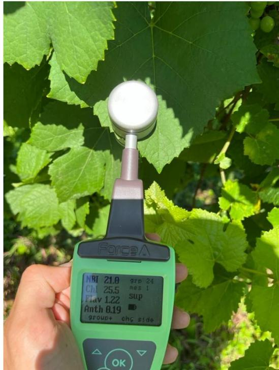
*Fig.6: misurazione con strumento "Dualex"*
