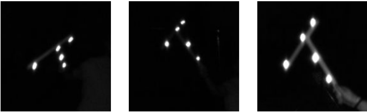
Figura 6.3: Nell'immagine si possono notare che i marker perdono la loro forma circolare.
