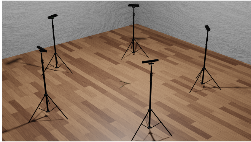
Figura 4.1: Formazione circolare delle telecamere adottata durante la calibrazione. Al suo centro è possibile notare la bacchetta utilizzata.
