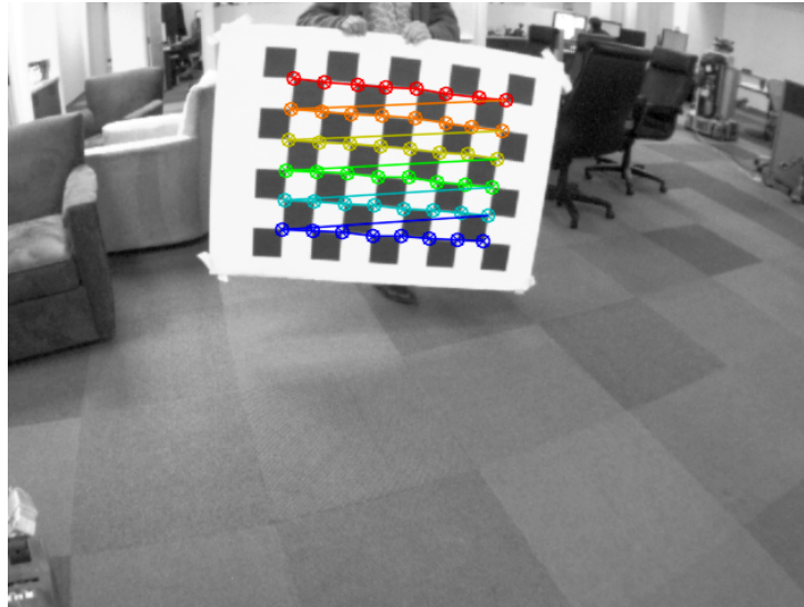
Figura 2.2: L'immagine mostra il processo di calibrazione effettuato con una scacchiera, di cui si sottolineano le notevoli dimensioni. Si può vedere chiaramente che gli angoli delle caselle sono stati correttamente identificati. [47]
