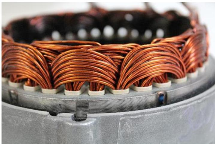
*Figura [11]: Estremità testata statorica con avvolgimenti circolari [34]*
