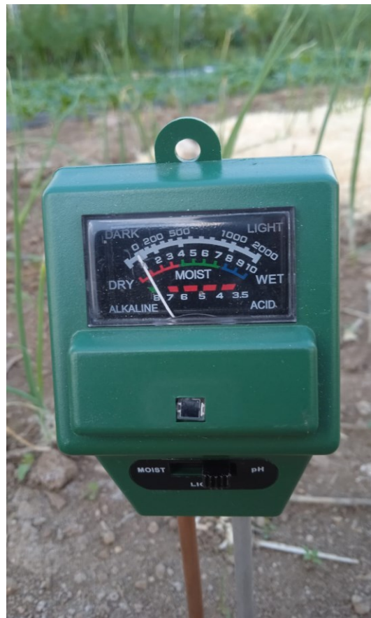
Figura 9. Strumentazione per misurare il pH e l'umidità del terreno (lo strumento misura con metodo elettrometrico l'Acqua Disponibile nel terreno valutata da 0 a 100% in scala da 0 a 10).
