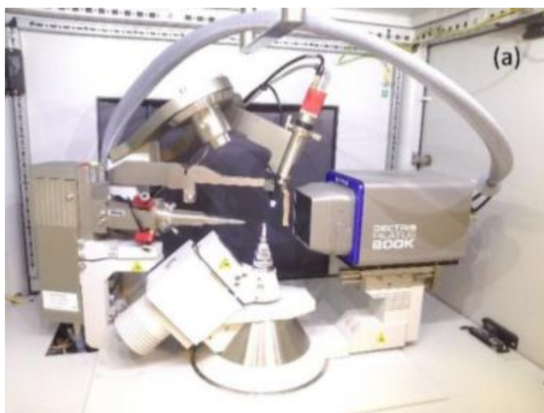
Figura 7. Diffratometro a cristallo singolo Rigaku-Oxford Diffraction Supernova con detector areale PILATUS 200K (Dectris) in dotazione al Dipartimento di Geoscienze dell'Università degli Studi di Padova .
