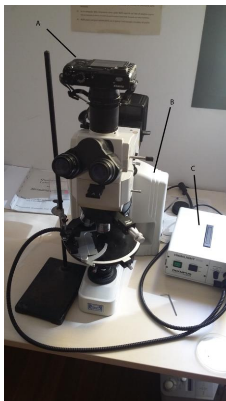
Figura 19. Strumentazione utilizzata per eseguire le foto dei campioni: (A) macchina fotografica; (B) microscopio con lampade sia per luce trasmessa che riflessa; (C) lampada alogena esterna a doppia sorgente di luce.
