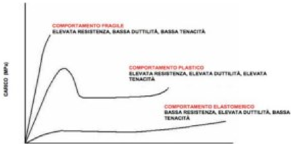
Figura 2.1.2: Comportamento dei materiali polimerici in funzione delle loro proprietà
