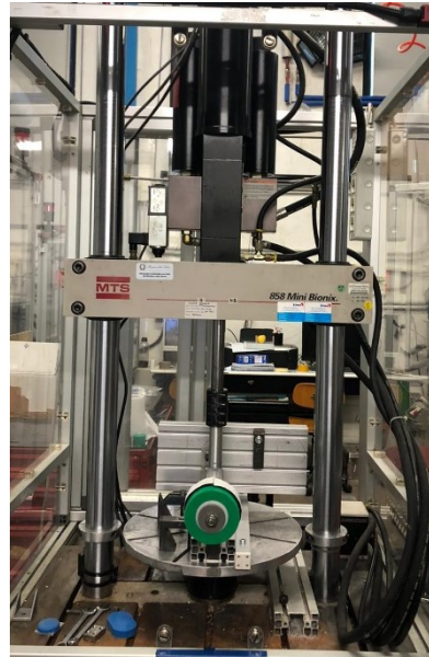
Figura 2.3: macchina biassiale MTS, Mod. MiniBionix 858
