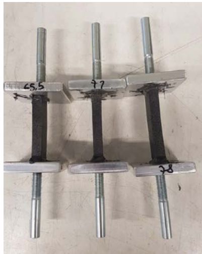
Figura A.5: Fotografia del campione di CFC già incollati sugli afferraggi della prova di trazione.
