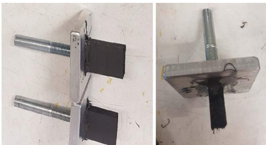
Figura 4.6: A sinistra la fotografia delle superfici di rottura delle prime prove a trazione. A destra la superficie di rottura delle nuove prove a trazione.
