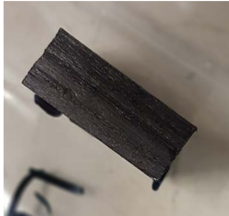
Figura 4.10: Fotografia della faccia dello spezzone ottenuto da una prova di taglio.
