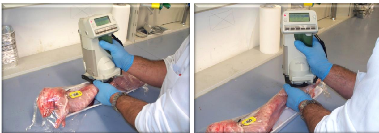
Figura 8. Misura del colore su longissimus lumborum e biceps femoris con colorimetro
