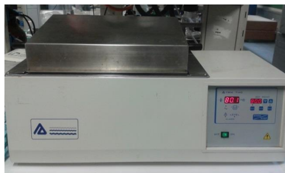
Figura 12. Bagno termostato a 80^{\circ}\text{C} utilizzato per la cottura della carne.
